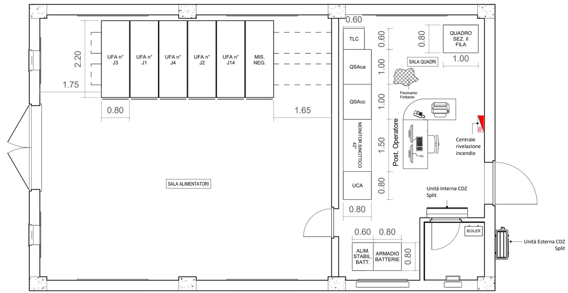
Pianta Fabbricato di cabina TE- Disposizione apparecchiature
