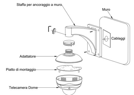
INSTALLAZIONE TIPO A MURO DI TELECAMERA DOME DA ESTERNO
