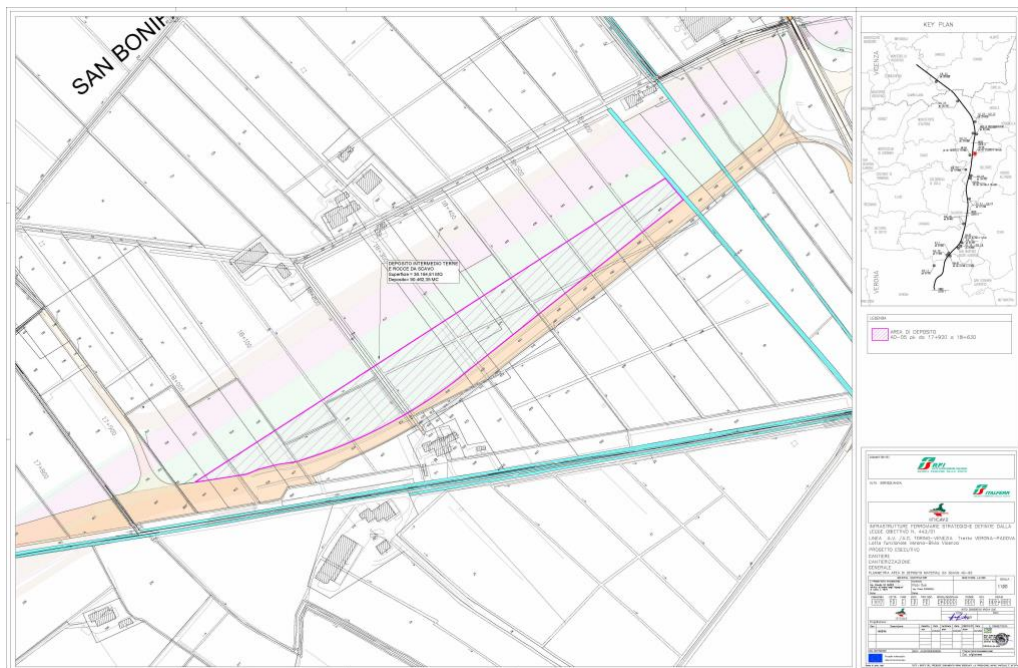
Figura 7 Layout Sito di deposito intermedio AD-05 – Area Deposito da pk 17+920 a pk 18+630
