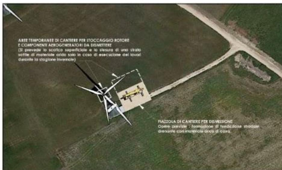
**Figura 2:** Esempio planimetria opere di cantiere
