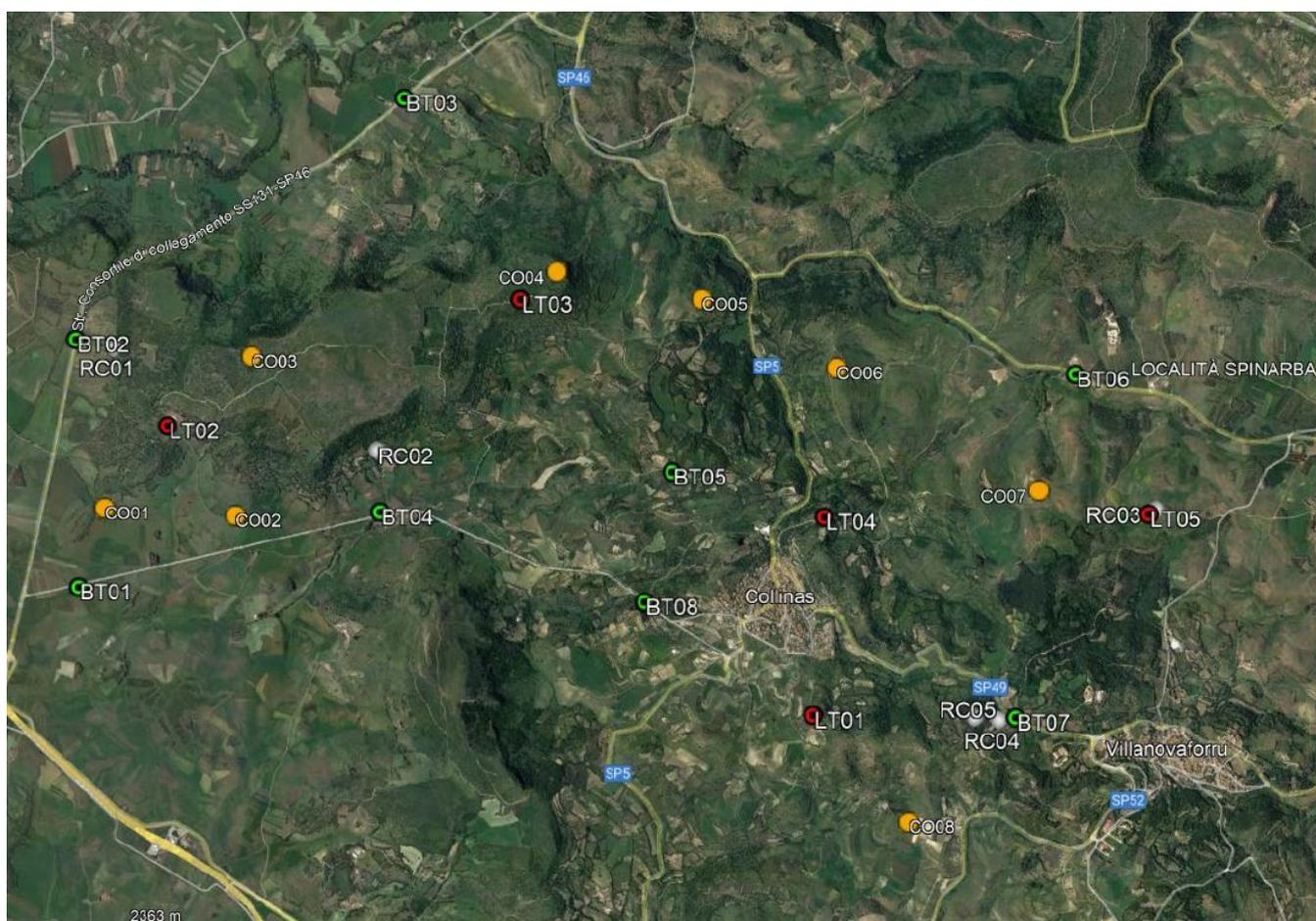
**Figura 4-1: Punti di misura a lungo (denominati LT-XX) e breve termine (denominati BT-YY)**
