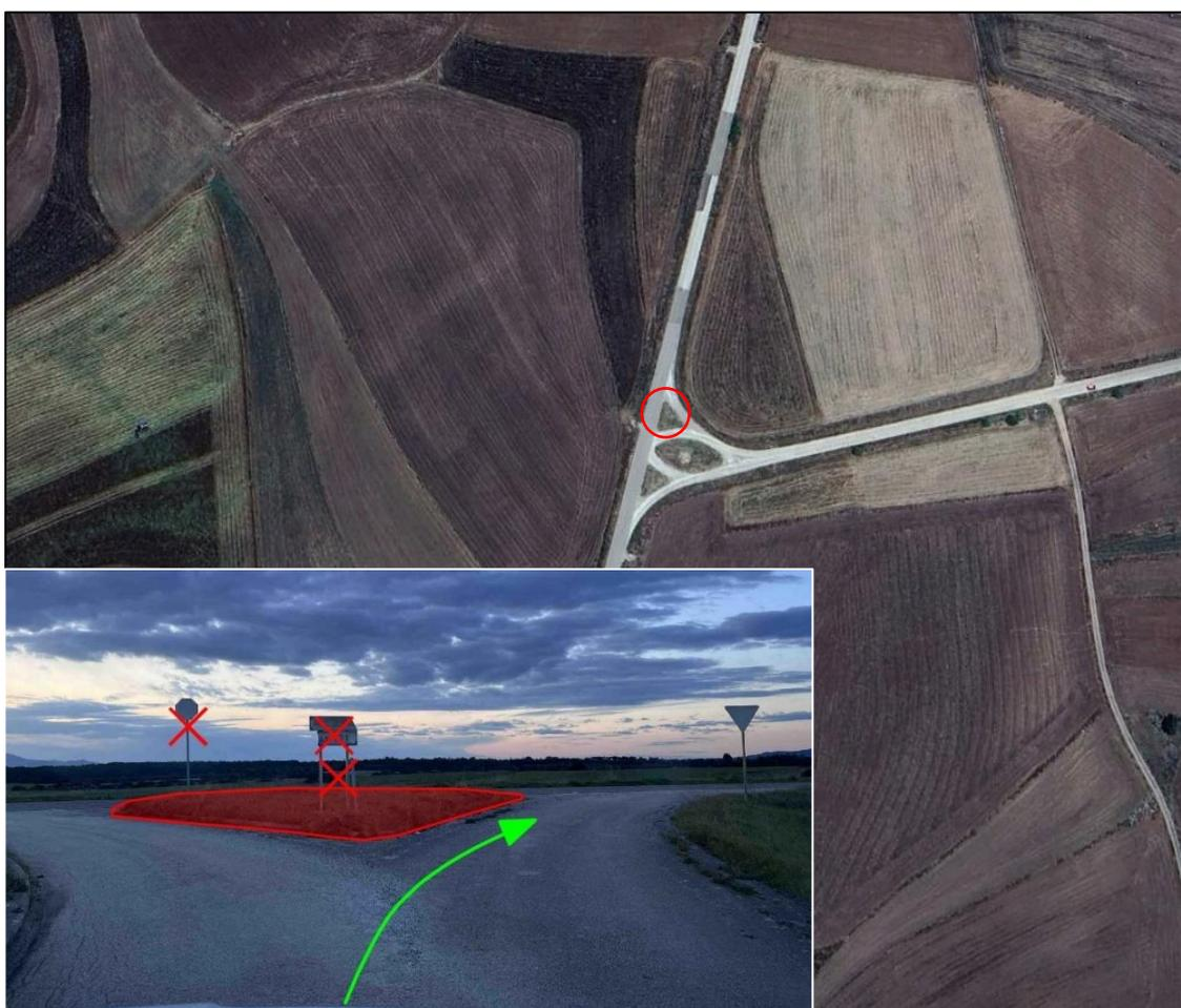
**Figura 5-20: Immissione in strada consortile di collegamento SS131/SP46 da SP53 – rimozione temporanea isola di traffico e segnaletica stradale (Intervento 19)**
