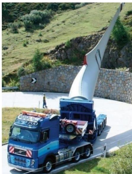
**Figura 3-2: Esempio di blade lifter**
