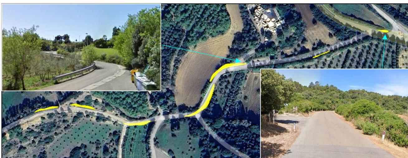
**Figura 5-27: SP49 e Viale dei Lecci – Realizzazione slarghi e rimozione temporanea degli ostacoli (Intervento 29 – 30)**
