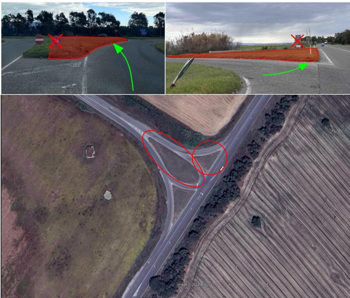
**Figura 5-9: Immissione in SP49 – rimozione temporanea isole di traffico e segnaletica stradale (Intervento 2 - 3)**
