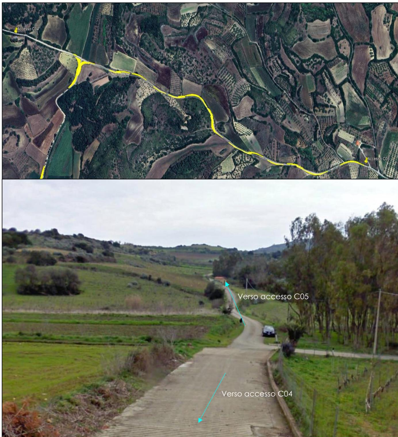
Figura 5-19: Tratti antistanti gli accessi agli aerogeneratori C04 e C05 – slarghi da realizzare (Intervento 18)
