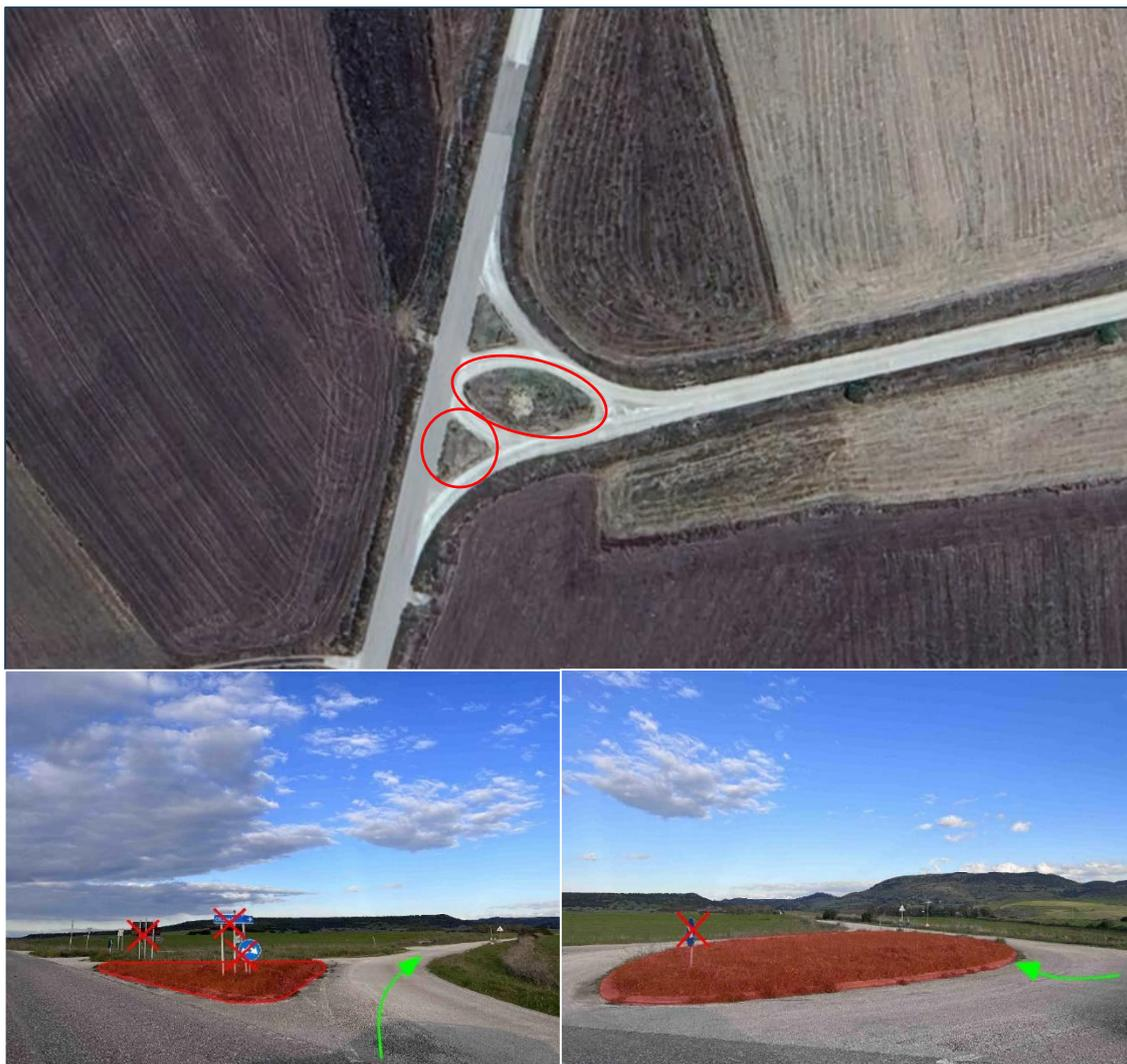
*Figura 5-13: Immissione in SP53 da strada consortile di collegamento SS131/SP46 – rimozione temporanea isole di traffico e segnaletica stradale (Intervento 7)*
