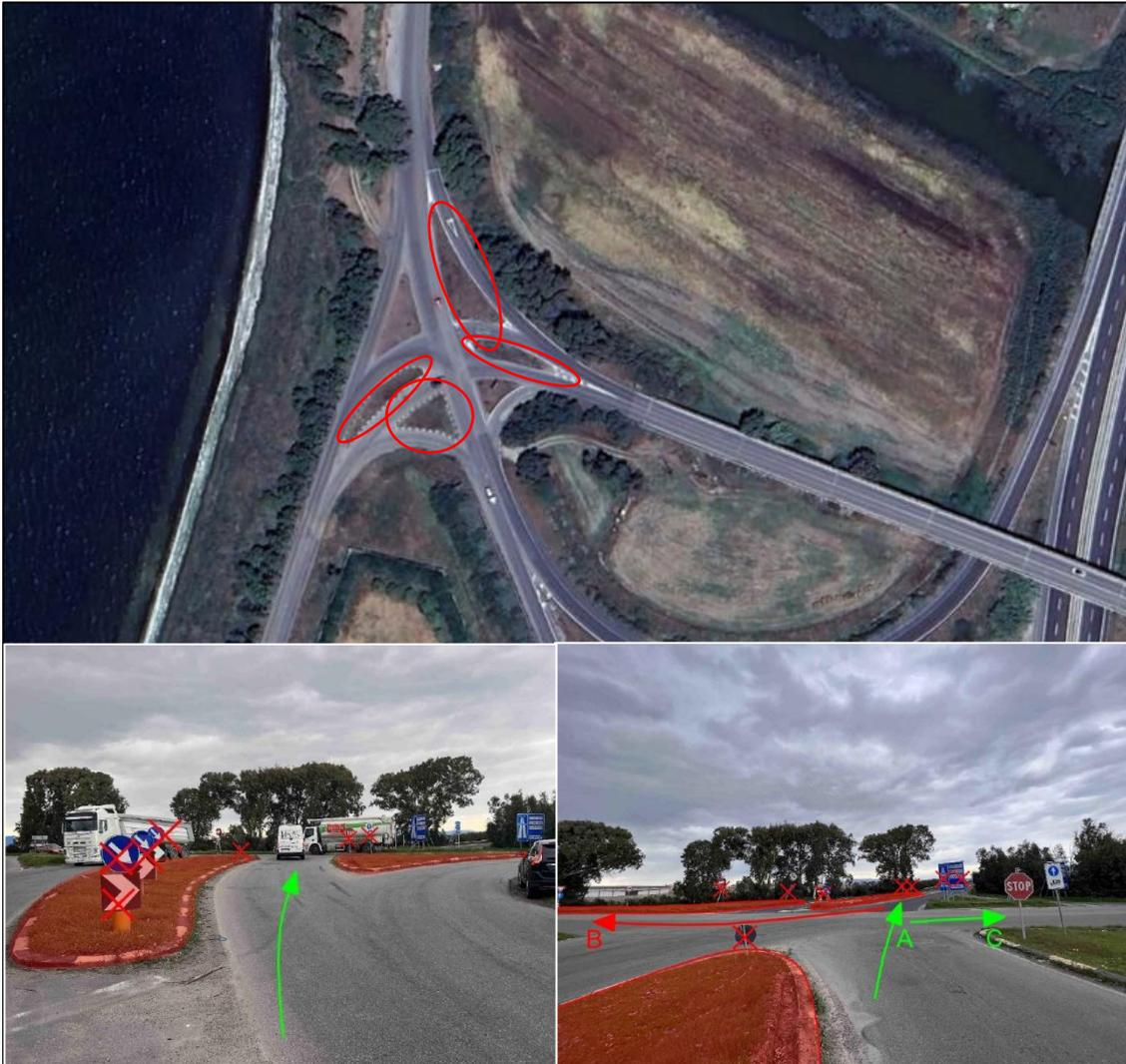
**Figura 5-11: Immissione in SS131 da SP49 – rimozione temporanea isole di traffico e segnaletica stradale (Intervento 4 – 5)**
