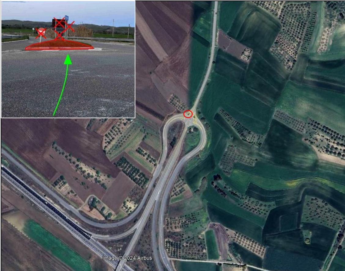
**Figura 5-24: Immissione in SP52 da Complanare Est – rimozione temporanea isola di traffico e segnaletica stradale (Intervento 24)**
