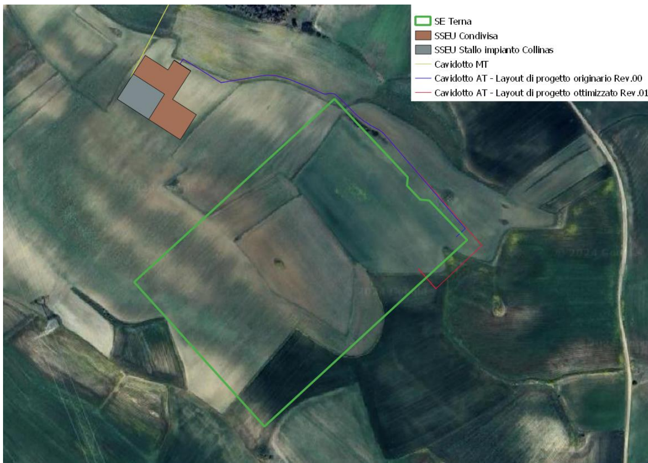
Figura 3-1: Confronto tra il percorso del cavidotto in AT originariamente previsto in blu (Rev.00) e il percorso dello stesso prolungato nel nuovo layout in rosso (Rev.01)
