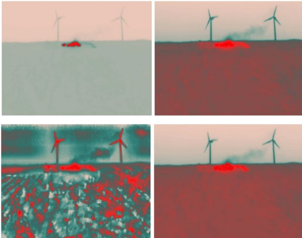
Figura 3-9: Confronto tra diverse tecniche di raccolta e rielaborazione di immagini ad infrarossi nel rilevare un incendio controllato in un contesto reale (fonte: Sousa MJ, Moutinho A, Almeida M. Thermal Infrared Sensing for Near Real-Time Data-Driven Fire Detection and Monitoring Systems . Sensors. 2020).
