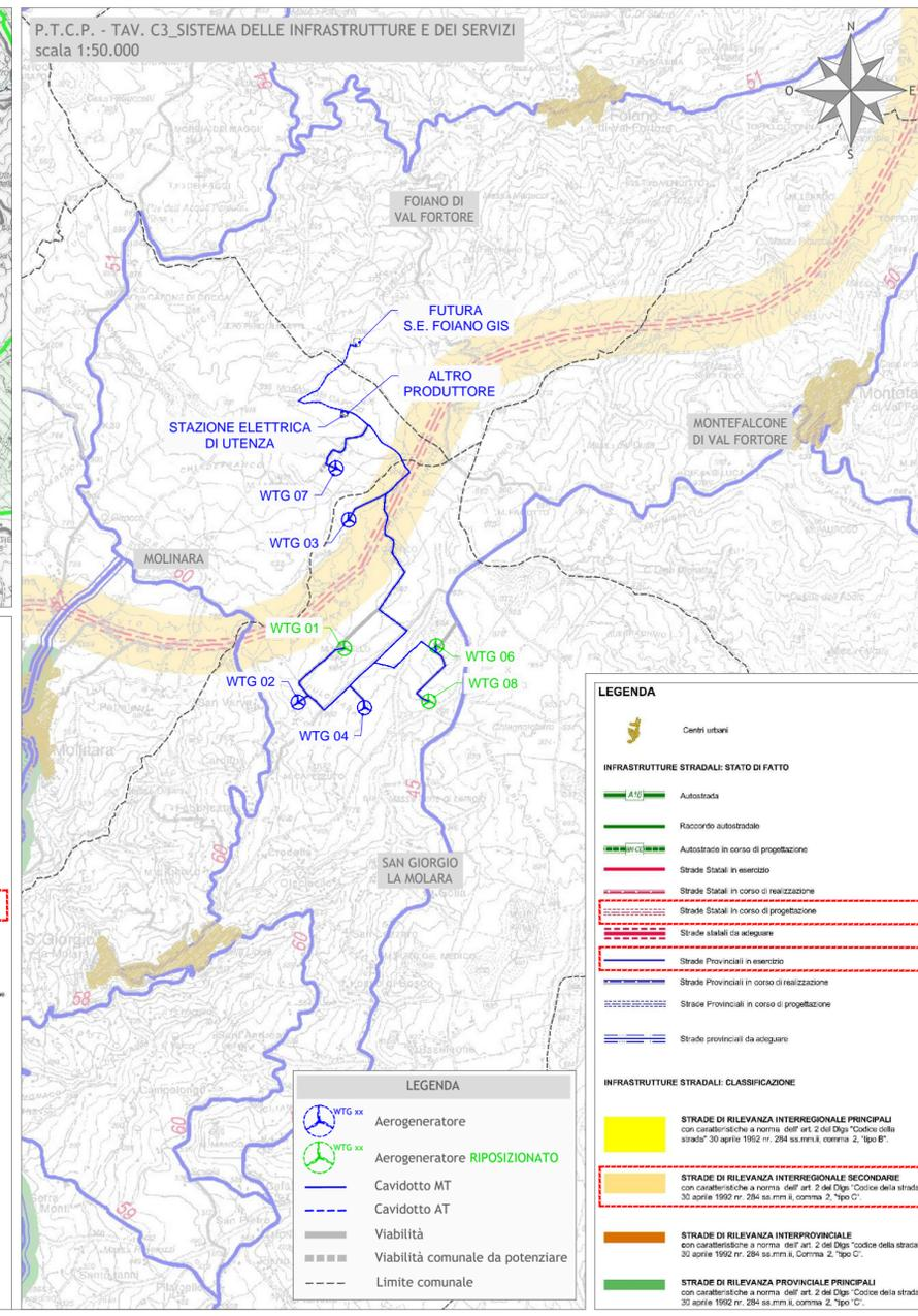
Impianto di produzione di energia elettrica da fonte Eolica e relative opere di connessione potenza complessiva pari a 48 MW
