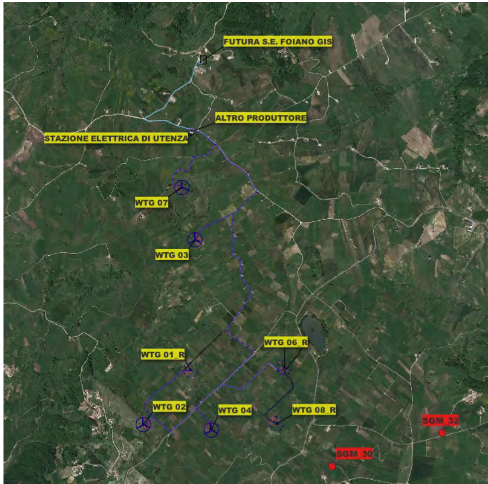
Immagine satellitare con individuazione del parco in esame e ubicazione dei sondaggi geognostici presi in esame (SGMS30 e SGM S32)
