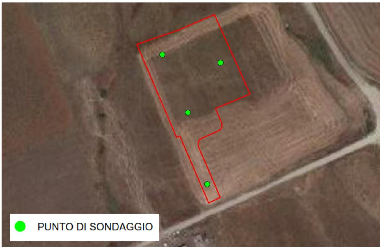
Figura 8 - Sondaggi previsti per l'area destinata alla CU e allo Storage
