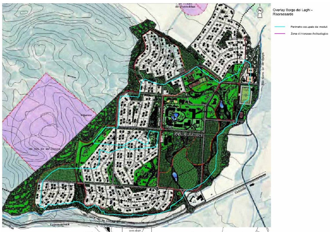
Sovrapposizione tra la lottizzazione Borgo dei Laghi e il perimetro dell’ impianto fotovoltaico
