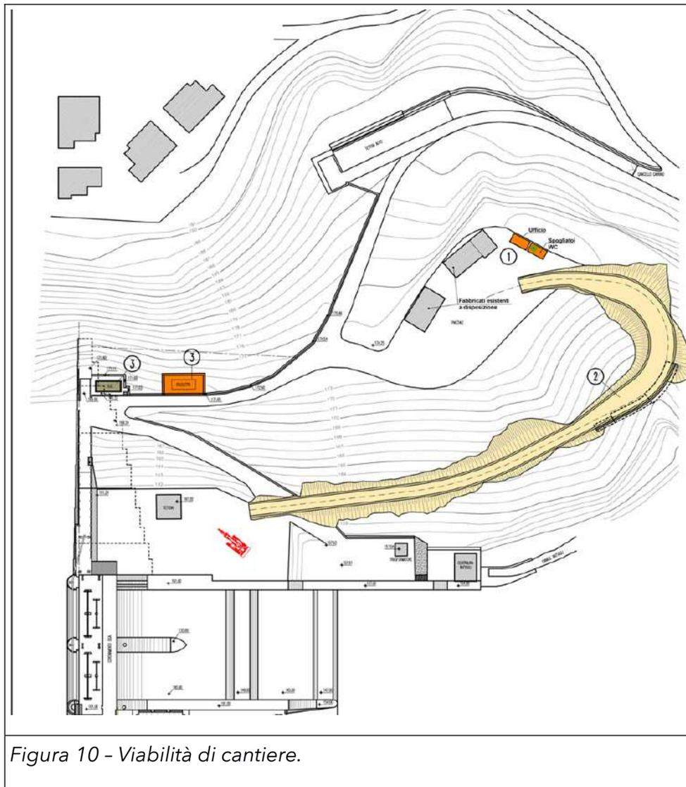
Figura 10 - Viabilità di cantiere.
