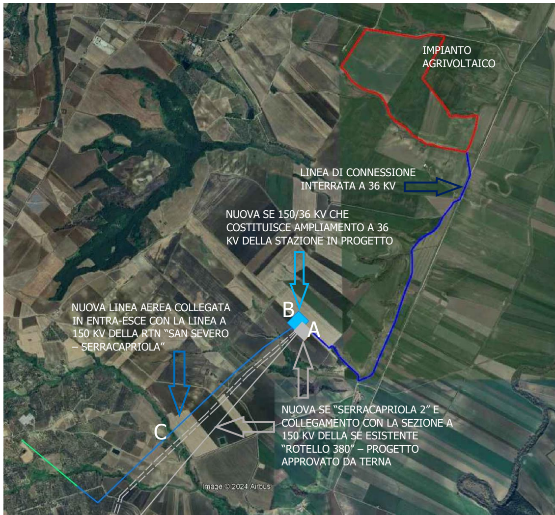
Rappresentazione schematica delle opere di connessione su base ortofoto
