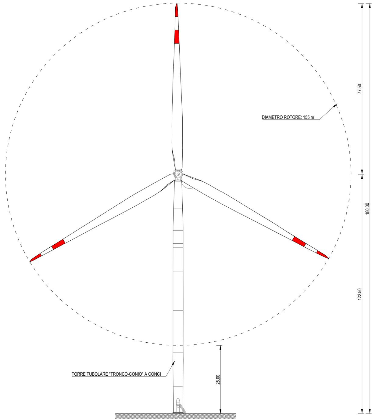
PROSPETTO FRONTALE DELL'AEROGENERATORE
