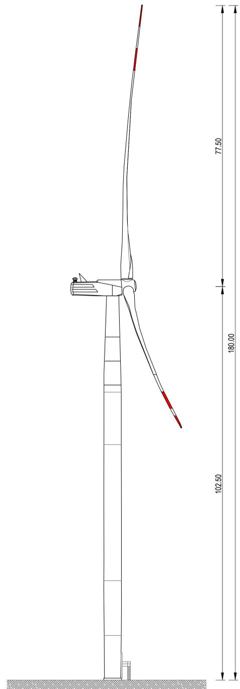
PROSPETTO LATERALE DELL'AEROGENERATORE
