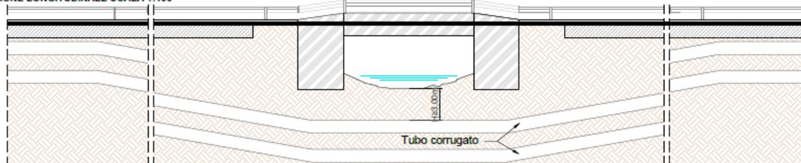
Figura 7 – Pianta e sezione longitudinale attraversamento trasversale ponte stradale in cls
