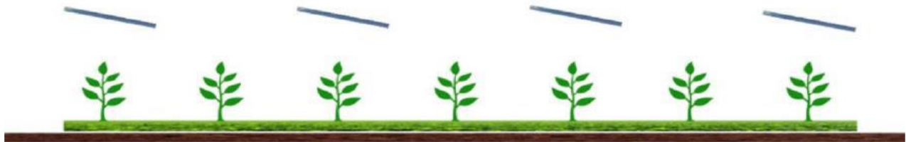
Figura 3-2 – Sistema agrivoltaico "avanzato" in cui la coltivazione avviene tra le file dei moduli fotovoltaici, e sotto a essi
