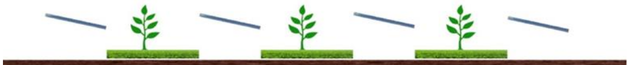
Figura 3-3 – Sistema agrivoltaico in cui la coltivazione avviene tra le file dei moduli fotovoltaici, e non al di sotto di essi
