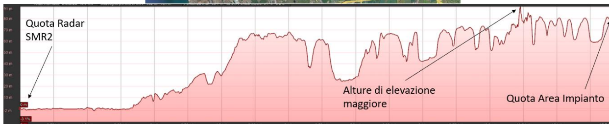
Figura 9 Verifica schermatura dal radar SMR2
