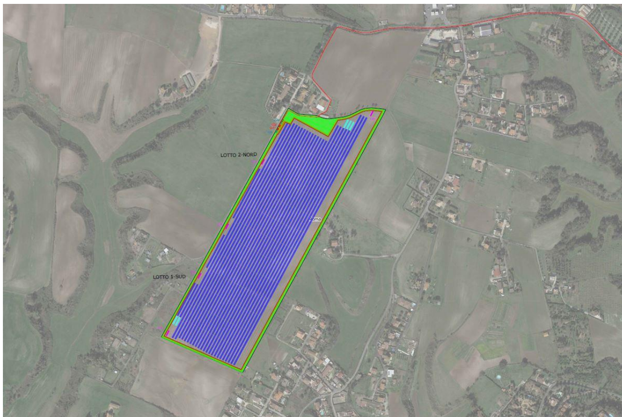
Figura 7 - Layout impianto FV su ortofoto
