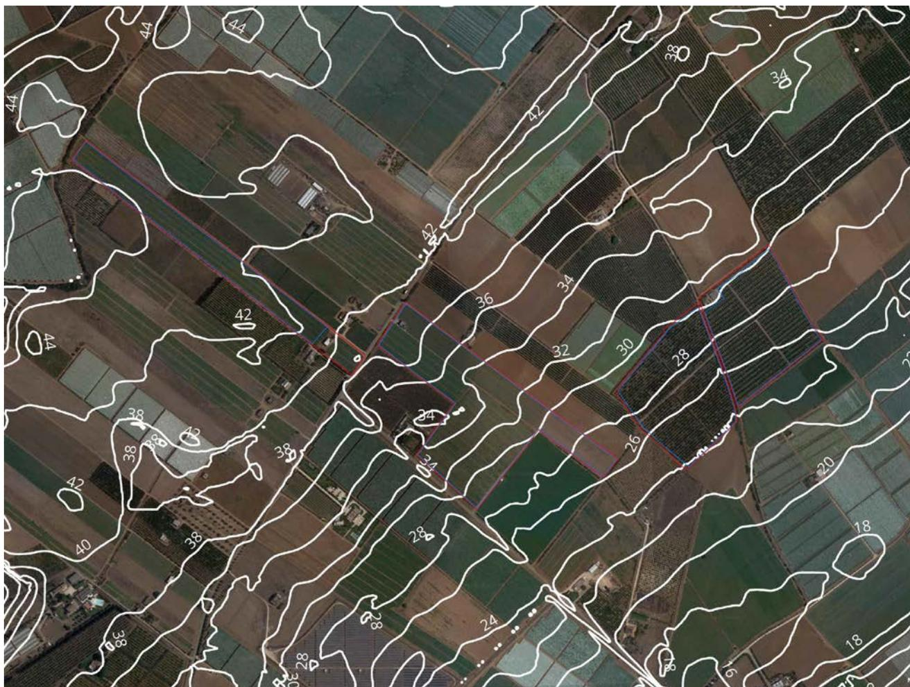
Figura 1: Individuazione dell'area di impianto "Blocco 1" con indicazione delle curve di livello ogni 2 m.
