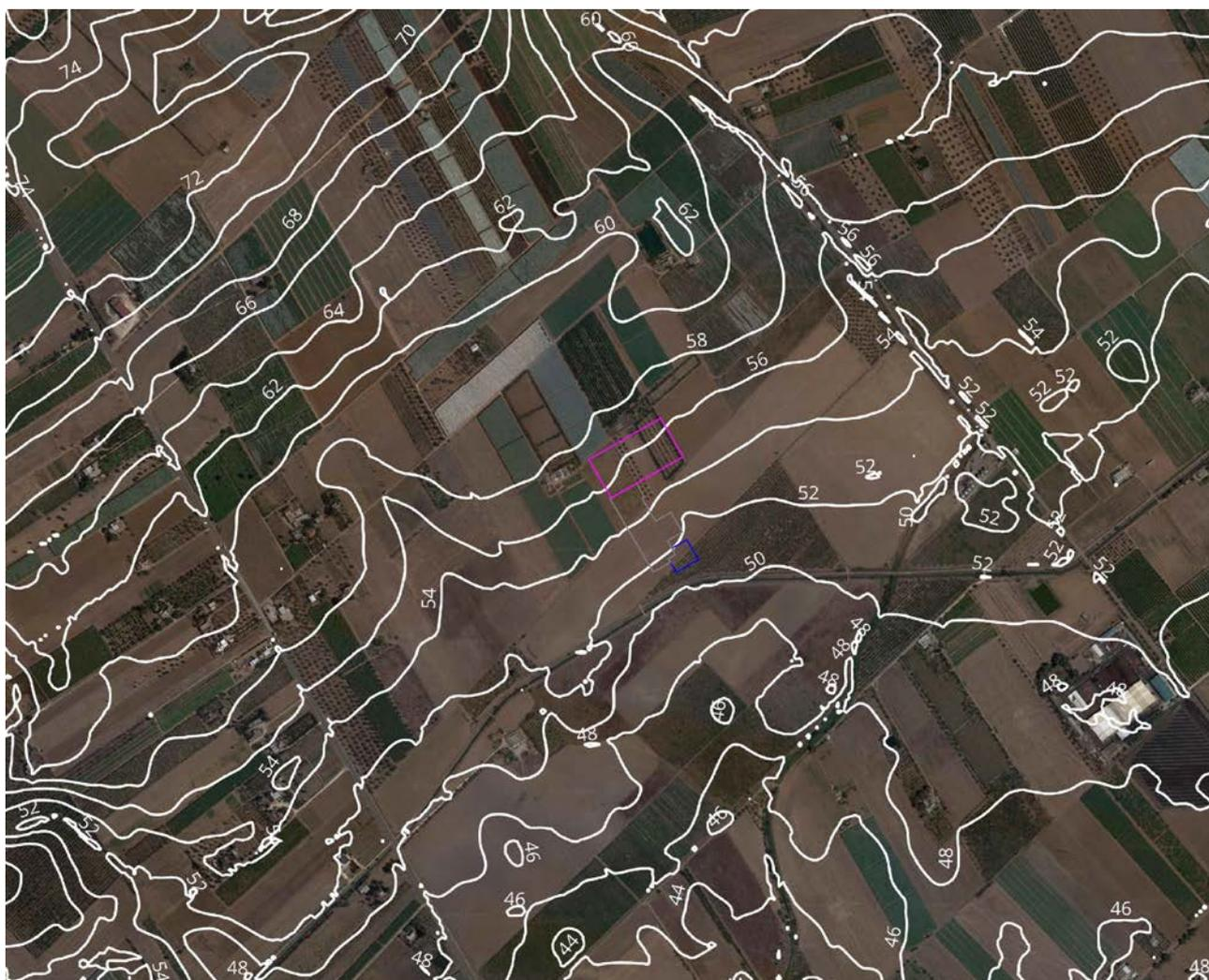
Figura 5: Curve di livello con dettaglio 2 m sovrapposte alla Stazione Elettrica Terna da realizzare, le parti comuni ed all'area per la realizzazione della stazione di elevazione (poligono verde in figura)
