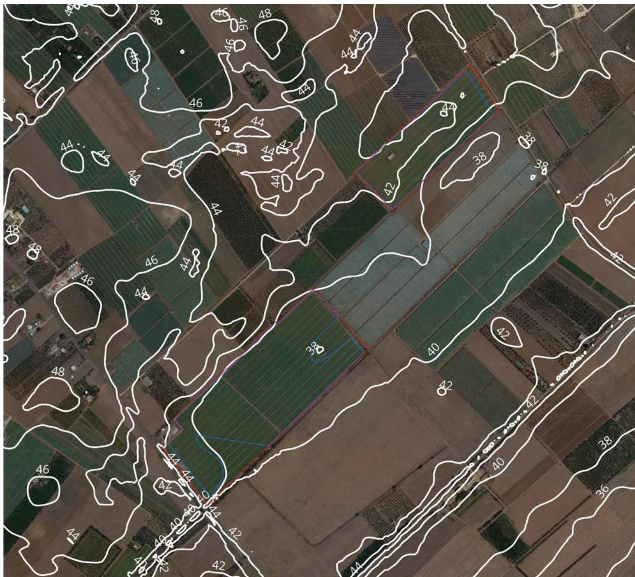
Figura 2: Individuazione dell'area di impianto "Blocco 2" con indicazione delle curve di livello ogni 2 m.
