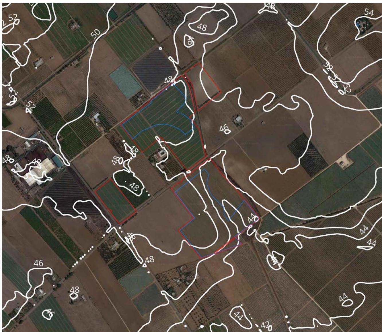
Figura 3: Individuazione dell'area di impianto "Blocco 3" con indicazione delle curve di livello ogni 2 m.
