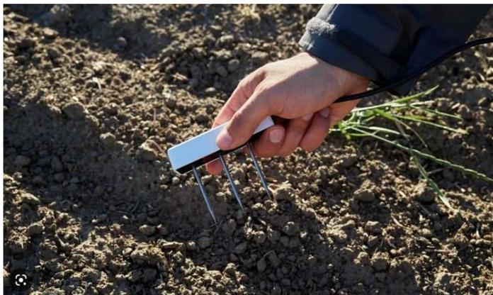
**Figura 4: Sensore TEROS12 (Meter) da inserire per il monitoraggio delle colture**
