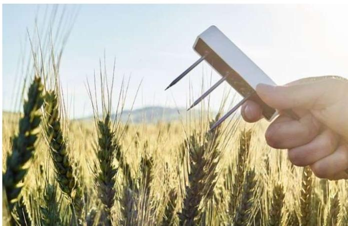
**Figura 5: Sensore TEROS12 (Meter) da inserire per il monitoraggio delle colture impiantate tra le interfile dei tracker**
