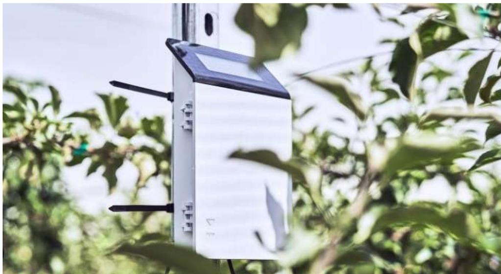
**Figura 2: Datalogger ZL6 (Meter) con 6 canali di ingresso da inserire in pieno campo**
