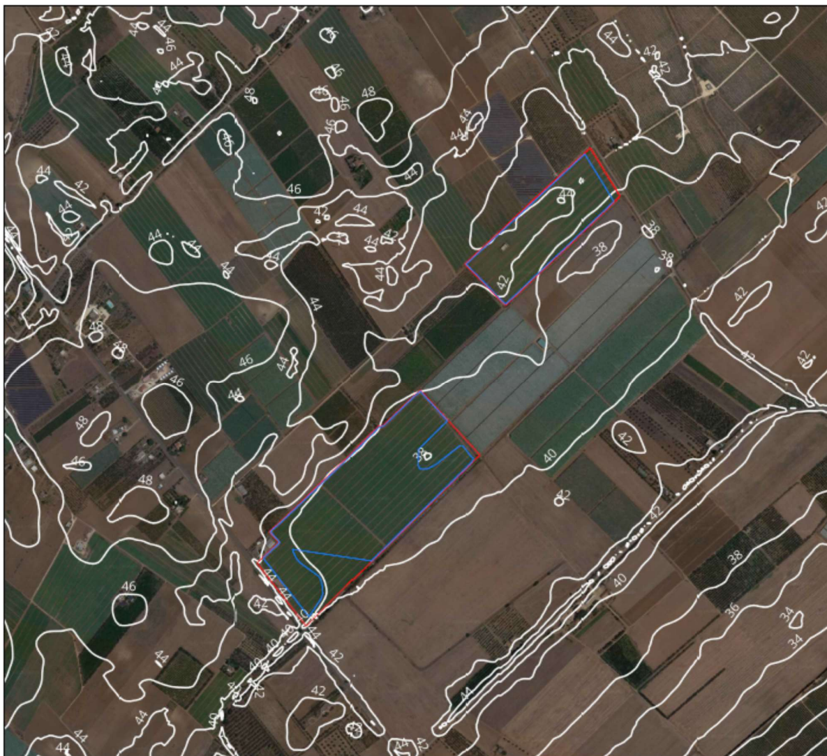
Figura 2: Individuazione dell'area di impianto (blocco 2) con indicazione delle curve di livello. Tutte le quote sono riferite al livello medio mare (scala 1:5.000)
