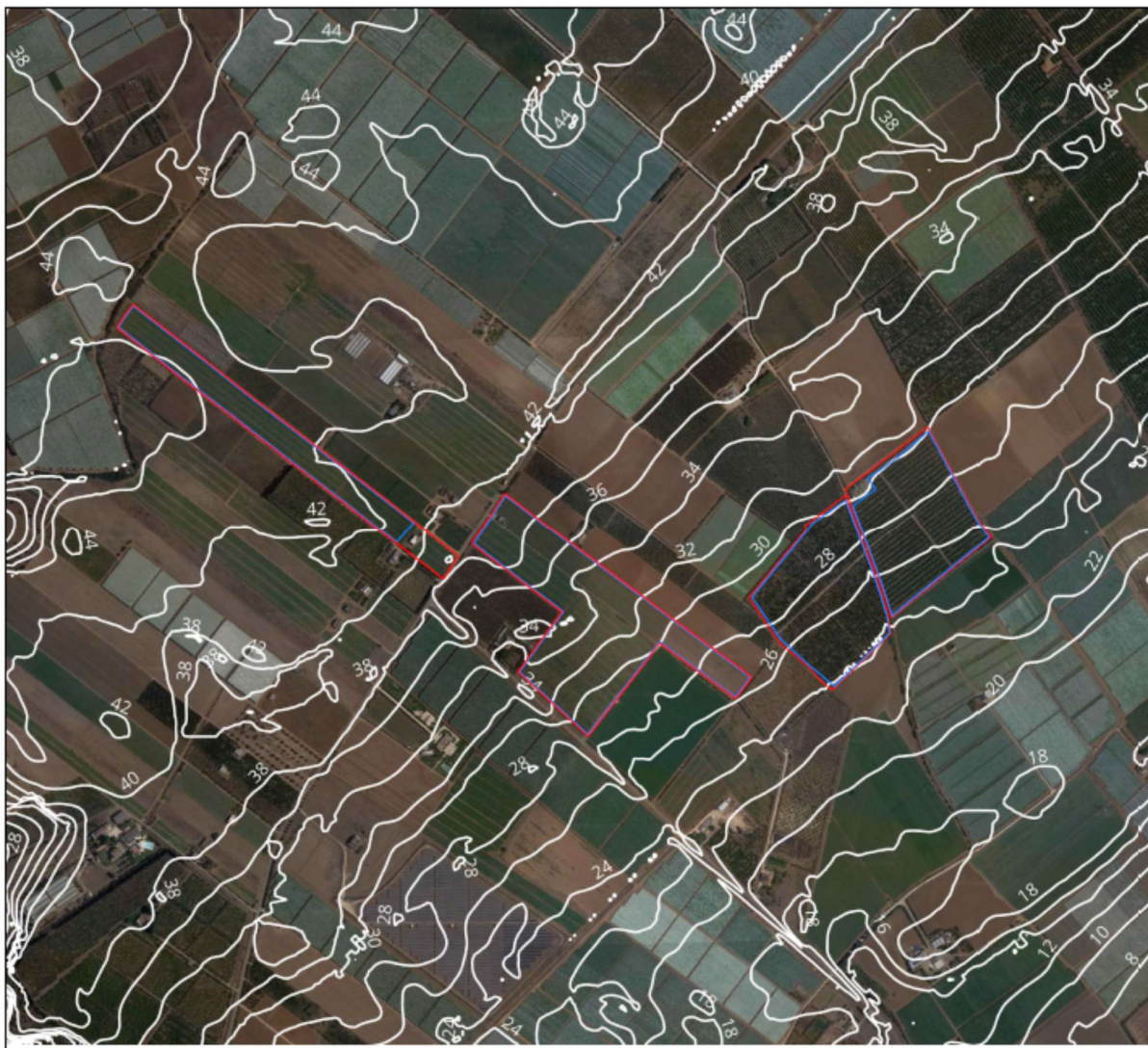
Figura 1: Individuazione dell'area di impianto (blocco 1) con indicazione delle curve di livello. Tutte le quote sono riferite al livello medio mare (scala 1:5.000)
