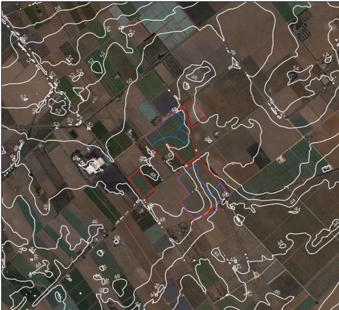
Figura 3: Individuazione dell'area di impianto (blocco 3) con indicazione delle curve di livello. Tutte le quote sono riferite al livello medio mare (scala 1:5.000)
