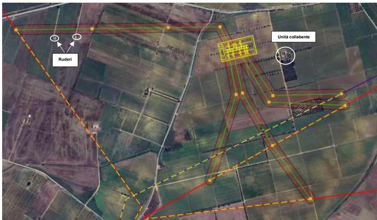
Figura 7-15 – Fascia di rispetto (DPA) sostegni 150 kV di nuova realizzazione su ortofoto
