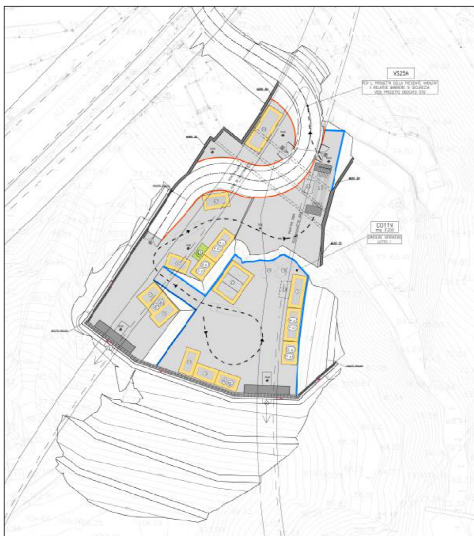
Apprestamenti di cantiere
