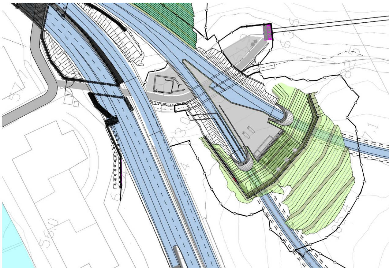
Figura 4-30. Sistemazione finale imbocchi gallerie Polcevera e San Rocco nella soluzione di variante
