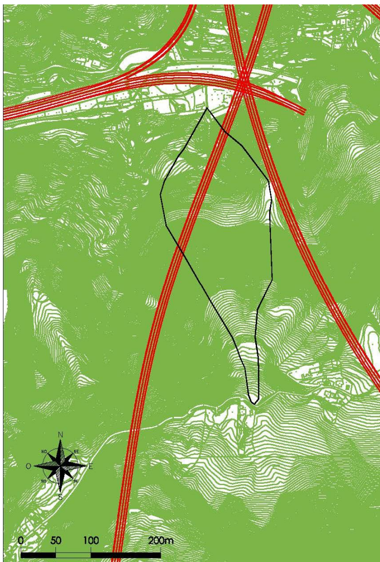
Figura 8-5 - Bacino imbrifero rio Vivaglietta, interferente con l'imbocco della galleria Montesperone lato Nord
