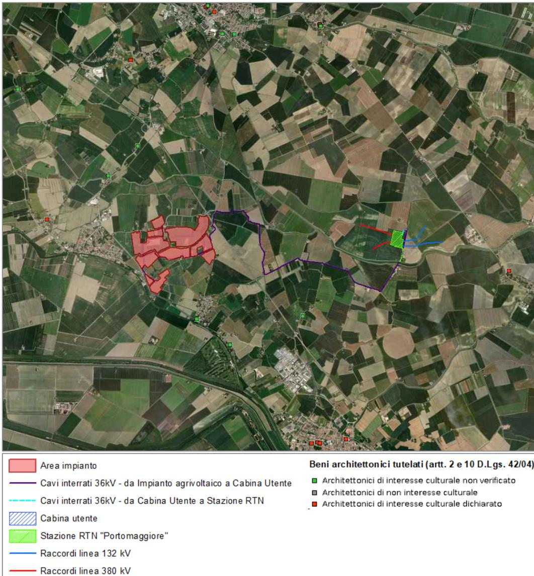
Figura 27: Estratto del portale "Vincoli in rete" del MiC riportante l'ubicazione dell'impianto agrivoltaico (in verde e arancio) e del cavidotto (in rosso) rispetto ai beni architettonici presenti nell'area vasta
