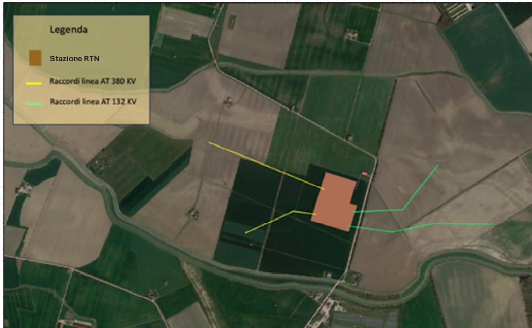
Figura 7: Dettaglio della cabina e dei raccordi di Linee AT
