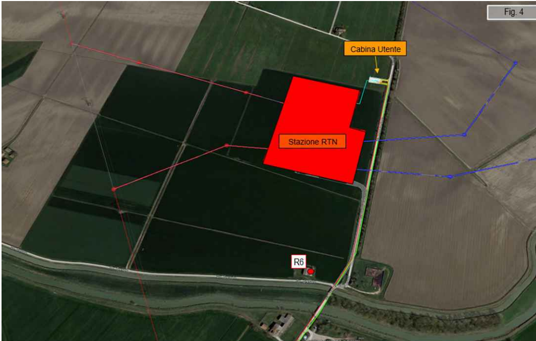
Figura 4: Quarto estratto di mappa aerea con ubicazione dei recettori presi come rappresentativi e rappresentativi degli edifici potenzialmente sensibili (R) rispetto alle aree dell'impianto agrivoltaico evidenziate in blu con limite magenta e in rosso area centrale di trasformazione
