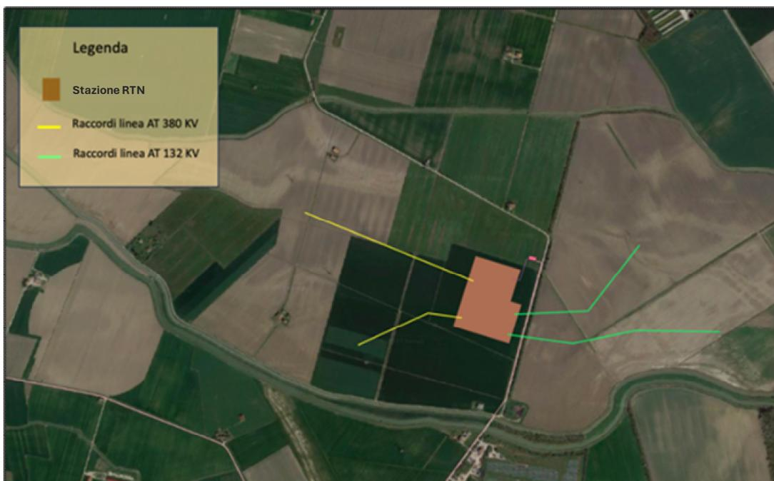
Figura 4: Dettaglio della cabina e dei raccordi di Linee AT
