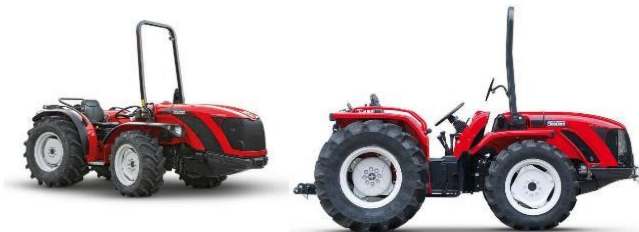
Figura 5-38- Trattore tipo frutteto dotato di arco abbattibile (ROPS)
