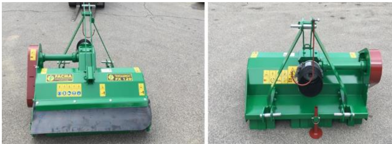
Figura 5-35- Trinciasarmenti compatibile con trattore 50 HP
