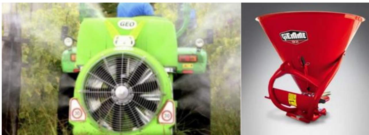
Figura 5-34- A sinistra atomizzatore per trattamenti fitosanitari, a destra spandiconcime, compatibili con trattore 50 HP
