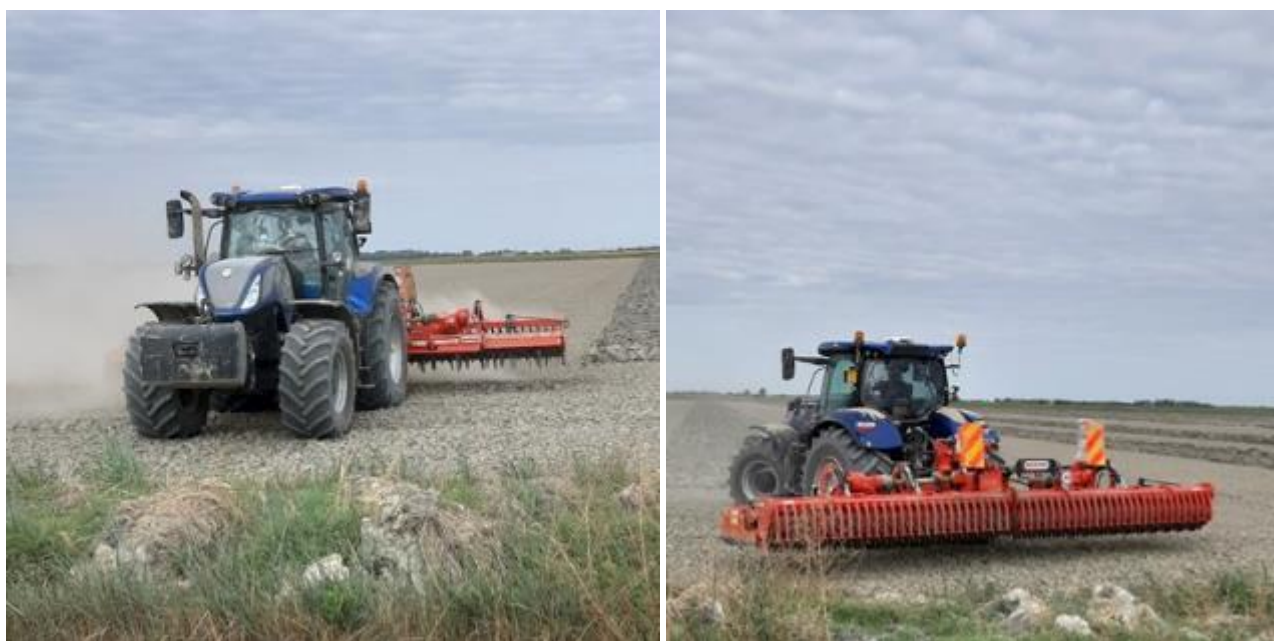
Figura 3-18 -Macchina combinata erpice rotante – rullo frastagliato: visione anteriore e posteriore
