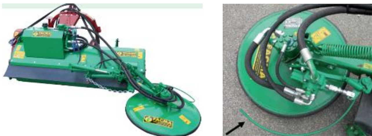
Figura 5-39- Trincia-sarmenti per diserbo meccanico con disco interfilare
