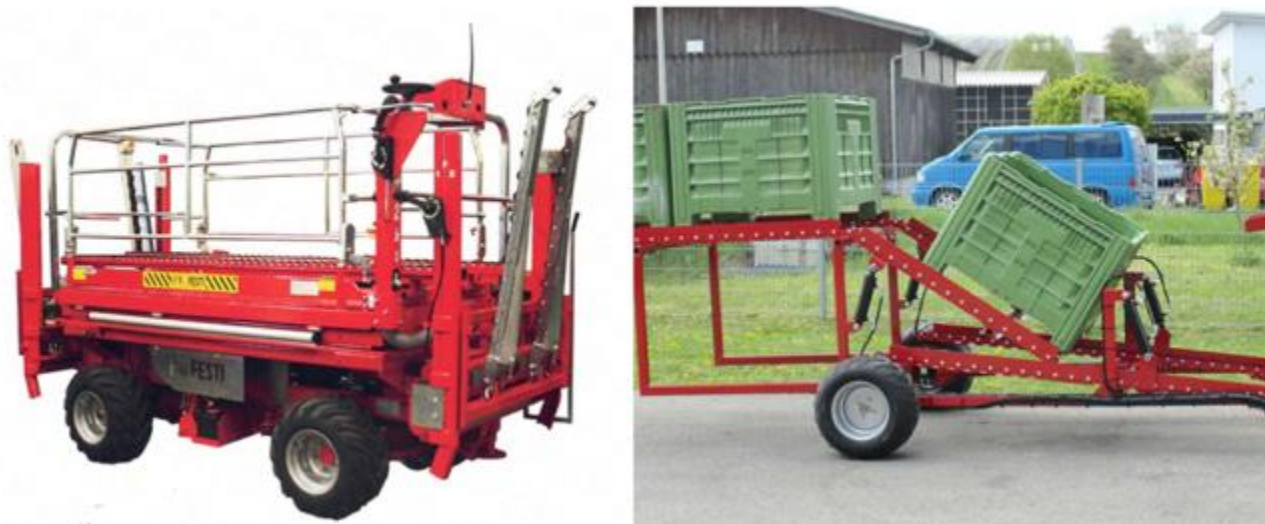
Figura 5-36- Carro semovente per raccolta e carrello per il trasporto dei prodotti in bins.
