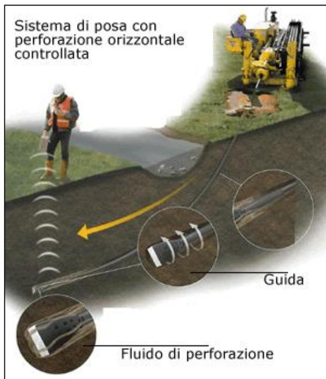
**Figura 4-1 - Macchina perforatrice (fonte web)**
