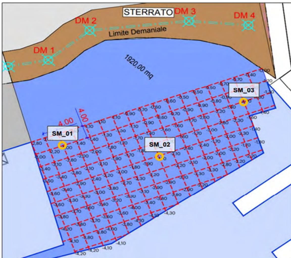
Figura 56 - Area di dragaggio e punti di campionamento.
