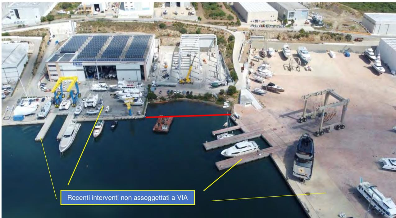
**Figura 1** – In giallo sono indicati i recenti interventi di banchinamento non assoggettati a V.I.A. nei lotti adiacenti. In rosso è indicata la banchina in progetto nel lotto di intervento, rappresentante la naturale prosecuzione della linearità delle banchine ad ovest. Vista da sud.
