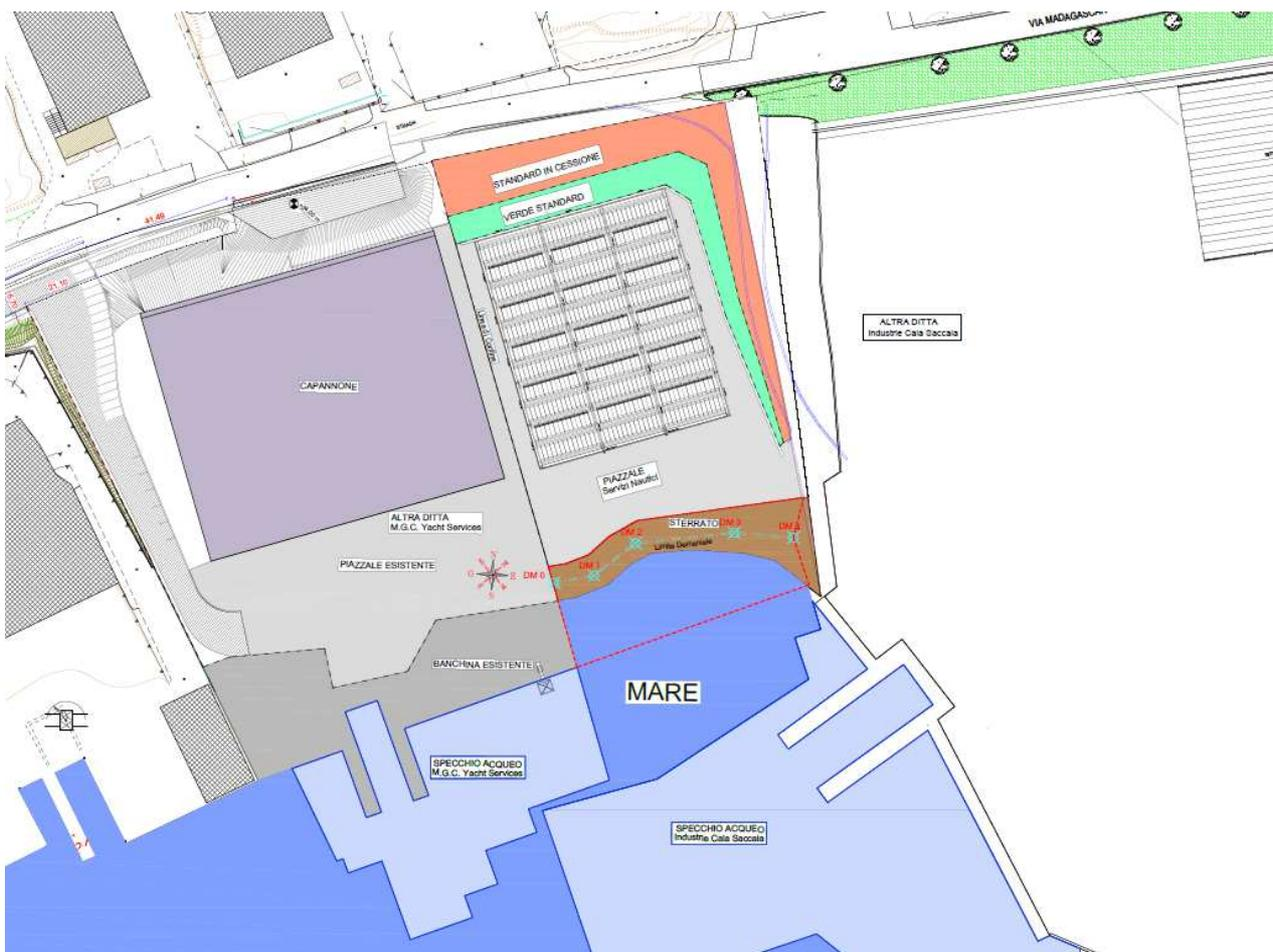
**Figura 2** – Stato di fatto. Il Tratteggio rosso indica le aree demaniali e di specchio d'acqua interessate dalla realizzazione della banchina. Si notino sulla sinistra e sulla destra gli interventi simili di banchinamento recentemente conclusi.
