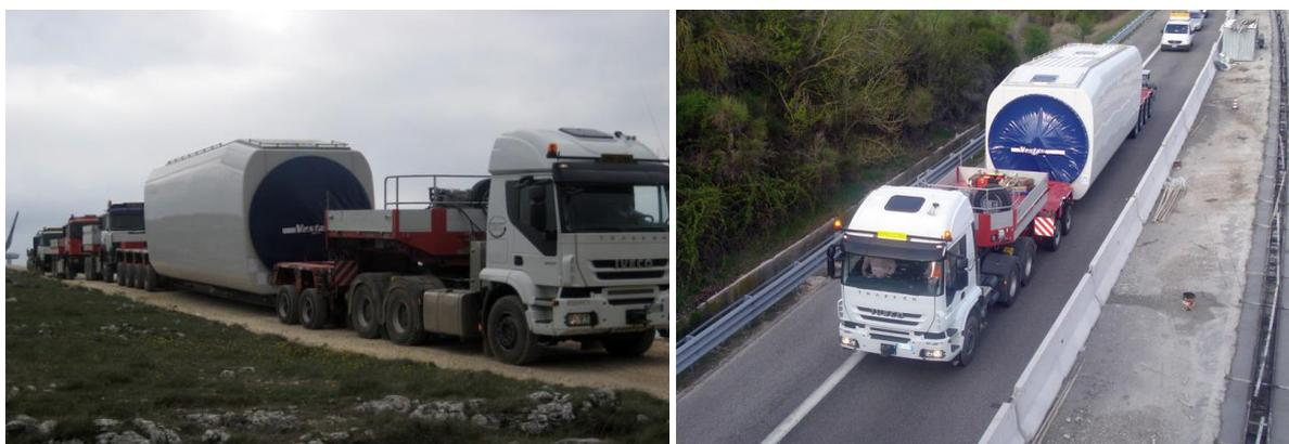
**Figura 28** – Esempio di trasporto Nacelle
