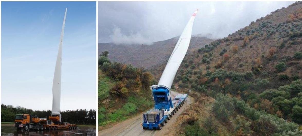
**Figura 26** – Esempio di trasporto con Blade Lifter Trailer
