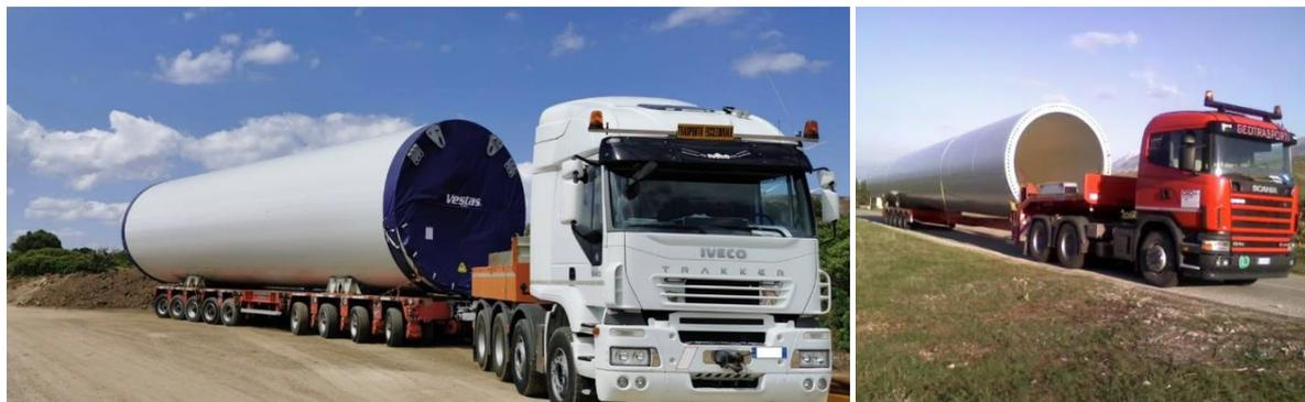
**Figura 27** – Esempio di trasporto con convogli a pianale allungabile per conchi di torre
