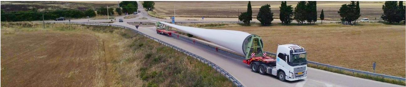
**Figura 24** – Esempio di trasporto con SWC (Super Wing Carrier)
