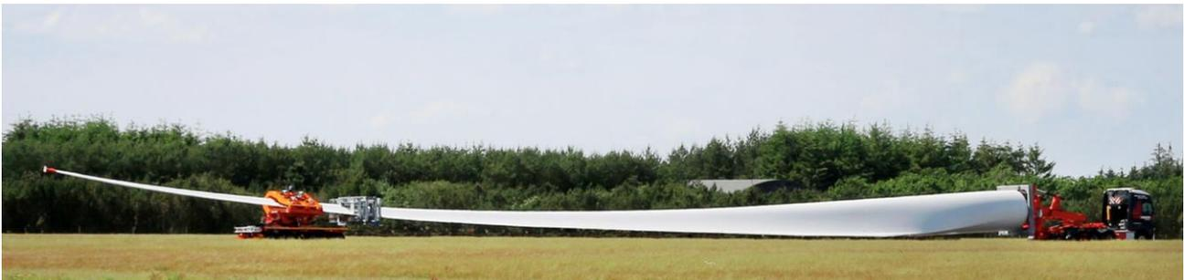
**Figura 25** – Esempio di trasporto con “RBTS” (Rotor Blade Transport System)
