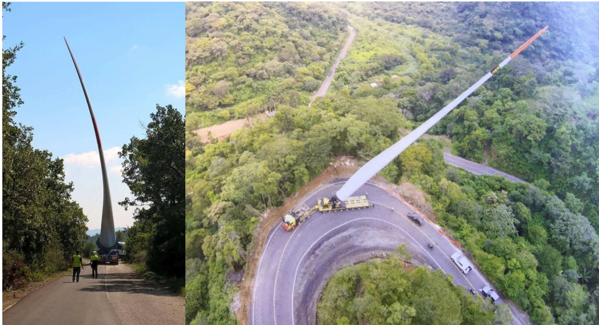
Figura 13 Esempio di trasporto con Blade lifter trailer
