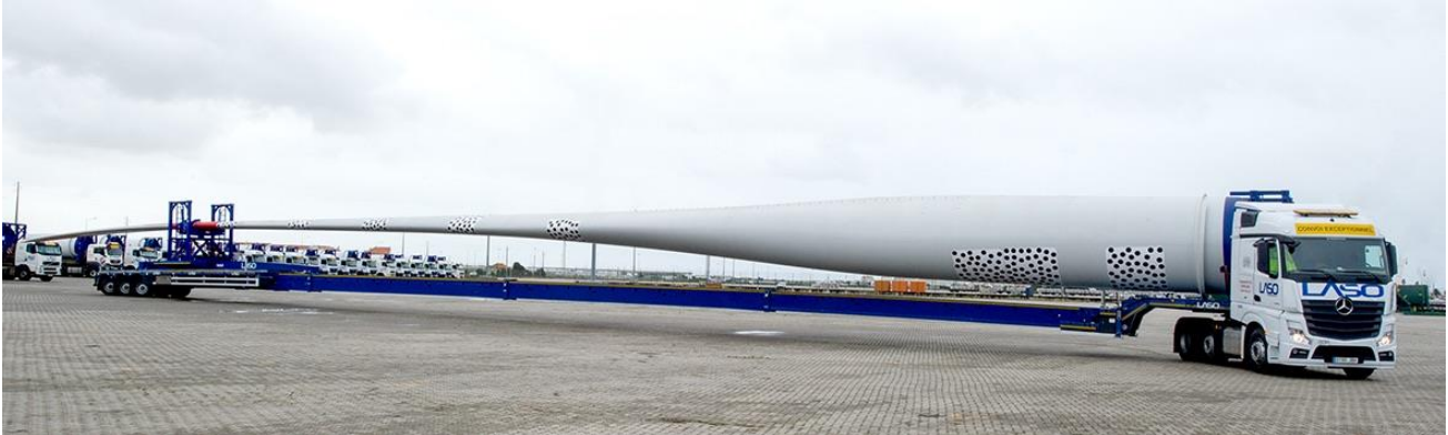
Figura 1 Esempio di trasporto pale con tipologia SWC
