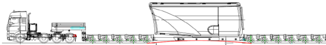
Figura 8 Schema tipo per il trasporto della navicella
