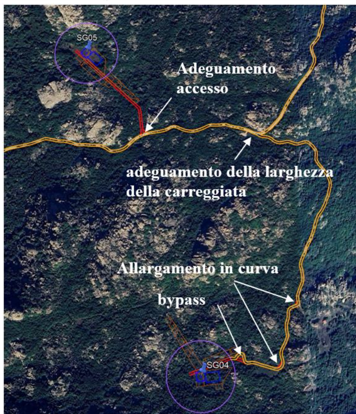
Figure 1 - Individuazione su ortofoto degli interventi sulla viabilità esistente per le wtg SG04 e SG05
