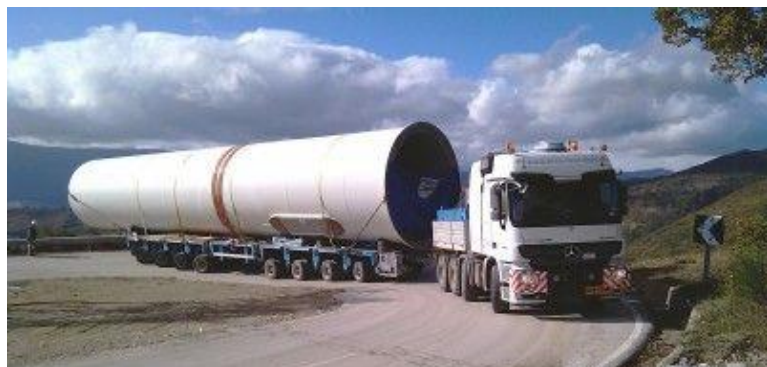
Figura 33 - Soluzione tipo del trasporto dei conici di torre con adeguamento in curva sulla viabilità esistente e del trasporto della navicella
