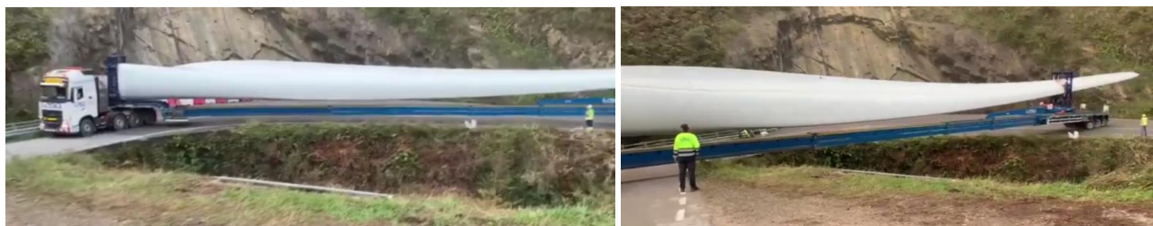
Figura 34 - Esempio di trasporto pale con tipologia SWC "Super Wing Carrier"
