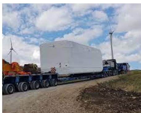
Figura 33 - Soluzione tipo del trasporto dei conici di torre con adeguamento in curva sulla viabilità esistente e del trasporto della navicella
