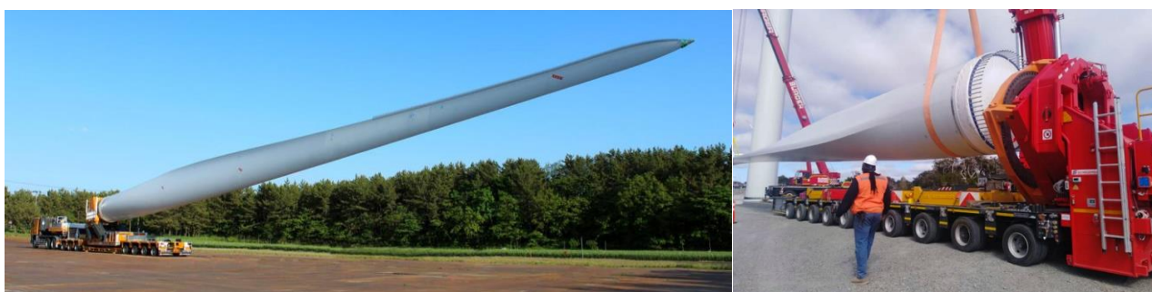
Figura 36 - Sistemi di trasporto pale: Blade Lifter Device
