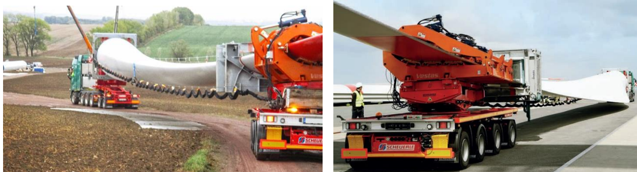
Figura 35 - Esempio di trasporto pale tipologia RBTS "Rotor Blade Transport System"
