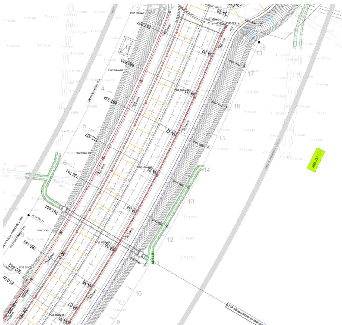
Figura 4-3 – Stralcio planimetrico sistema di drenaggio Svincolo Milano Oltre – Rampa A e B
