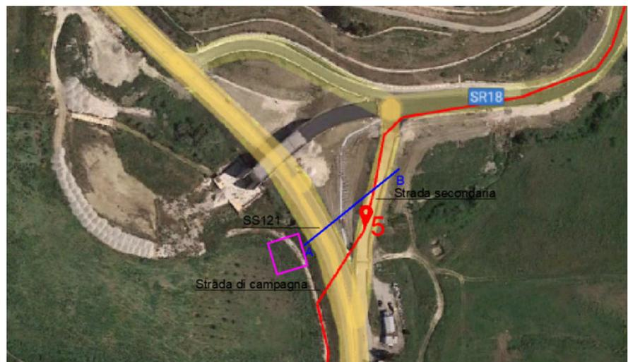
**Figura 5.** Planimetria per il posizionamento della macchina per effettuare il TOC
