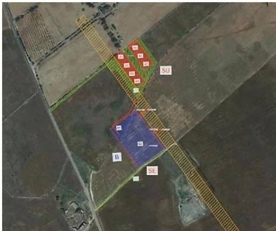
Figura. Inquadramento Stazione di Elevazione Utente (S.E.U.) e Stazione Elettrica (S.E.) Terna.
