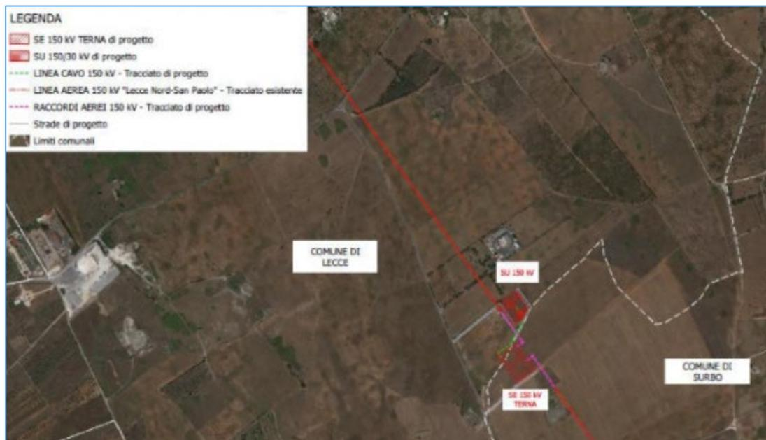
Figura. Inquadramento della SEU e della SE su base ortofoto. La nuova Stazione Elettrica TERNA e le Stazioni di trasformazione del Proponente sono ubicate al limite dei confini comunali tra Lecce e Surbo (LE), in prossimità della SP 236 in località Campore.
