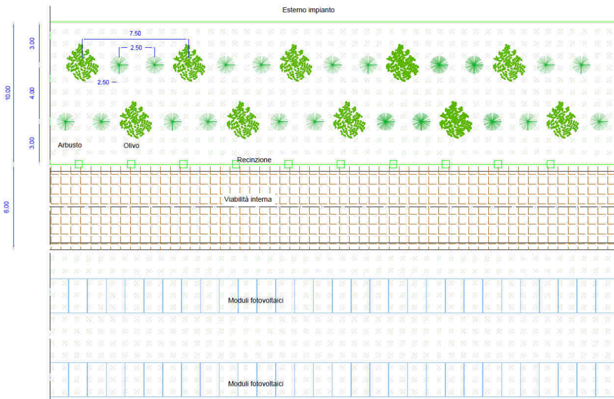
Fascia di mitigazione perimetrale (pianta)
