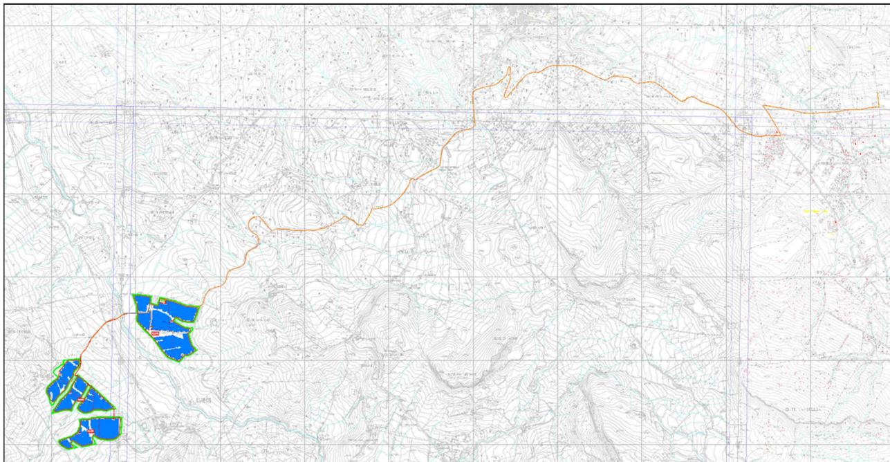
*Elettrodotto interrato di collegamento su CTR tra la centrale fotovoltaica e la futura SE RTN 150/36 kV*
