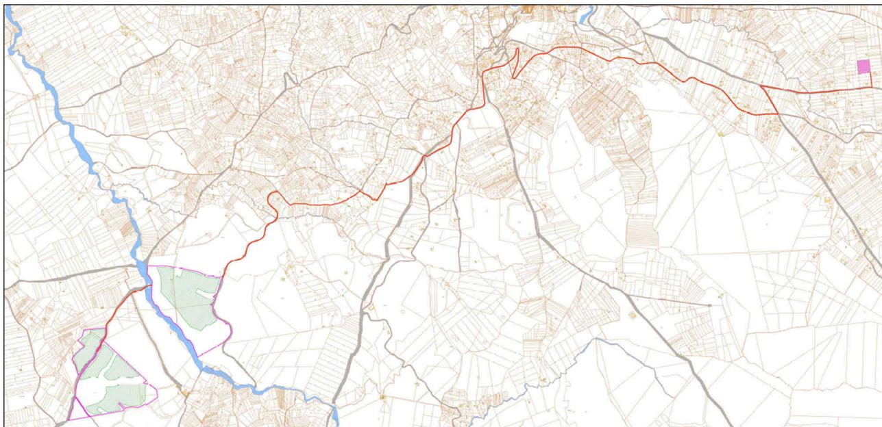
*Elettrodotto interrato di collegamento su catastale tra la centrale fotovoltaica e la futura SE RTN 150/36 kV*
