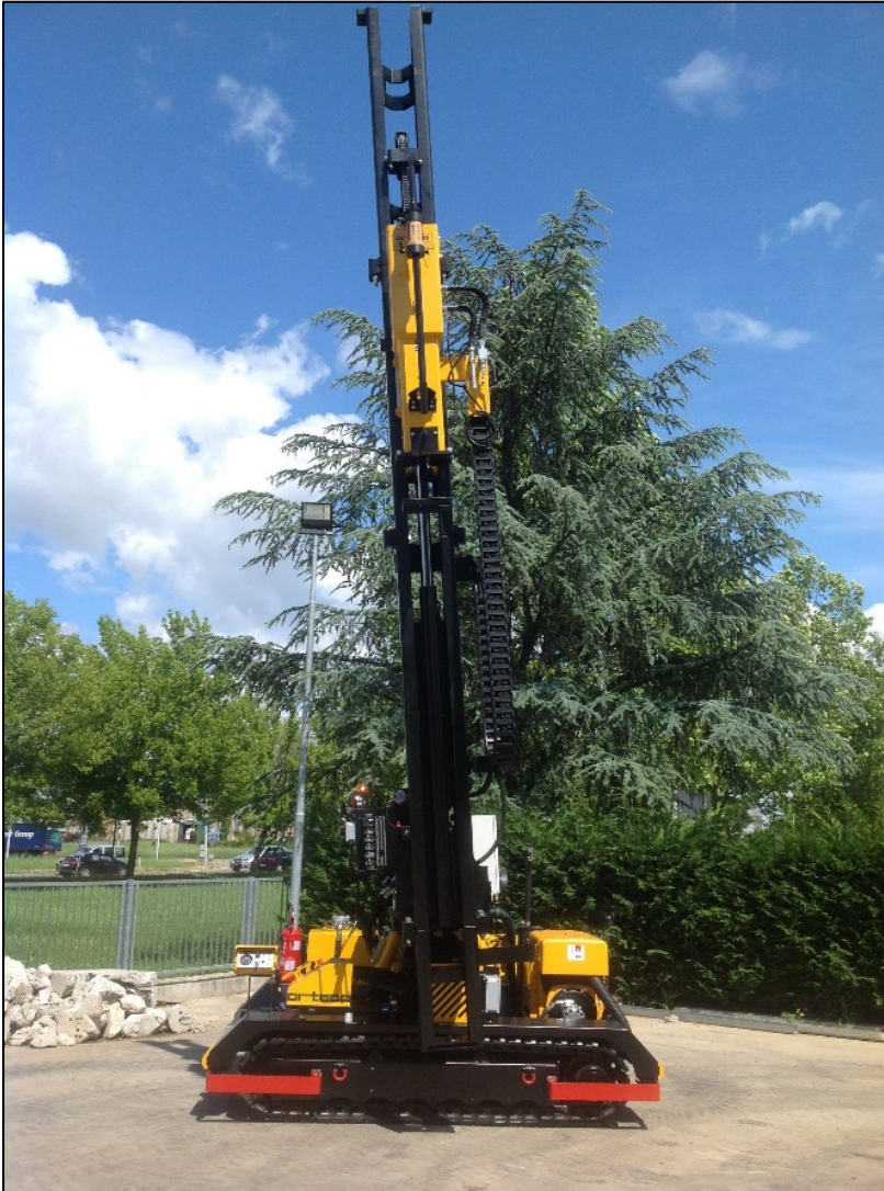
Figura 31: Macchina battipalo per l'infissione dei pali per i tracker
