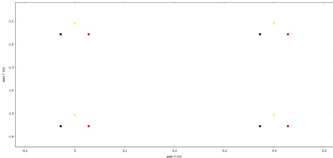
Figura 32: Cavidotto di collegamento MT, 4 terne, geometria
