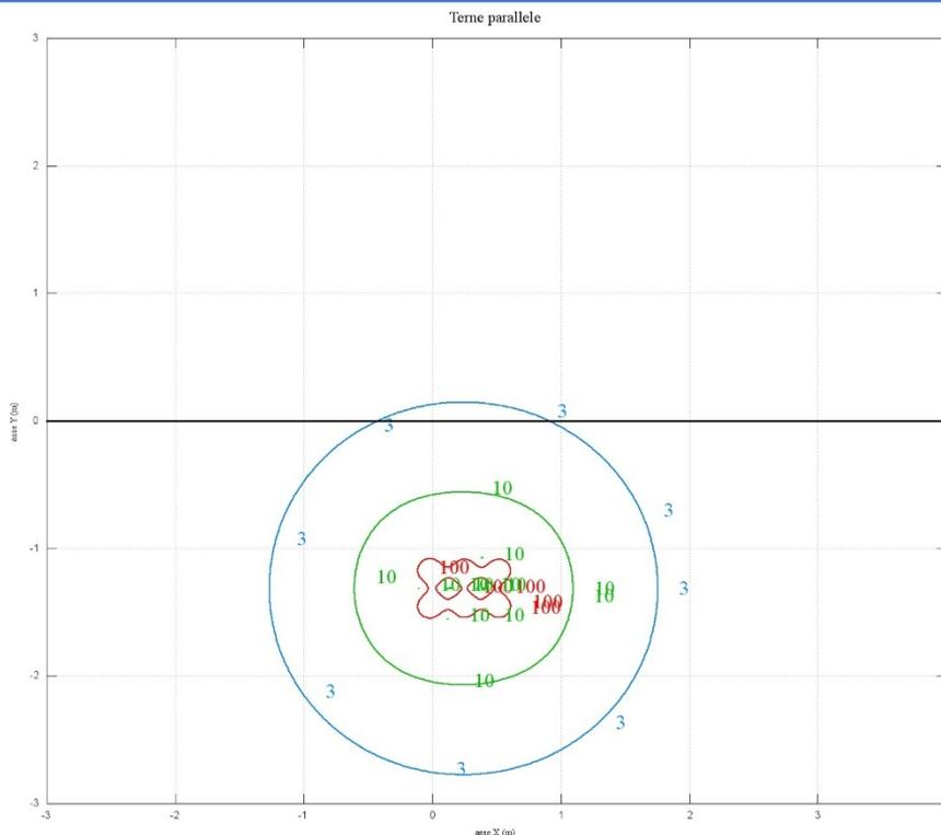
Figura 10: Anello 2, Anello 3, Anello 4, 6 terne, curve isolivello
