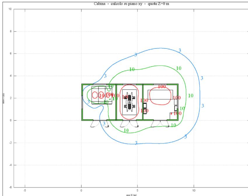
Figura 24: Cabina di campo,  $h = 0$  m, curve isolivello
