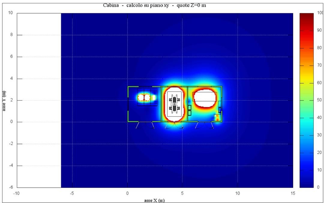
Figura 23: Cabina di campo,  $h = 0\text{ m}$ , curve isolivello
