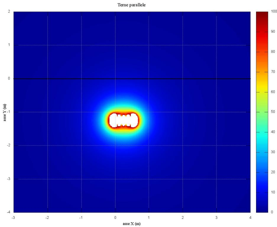
Figura 15: collegamento BT Inverter-Cabina, 10 terne, mappa 2D
