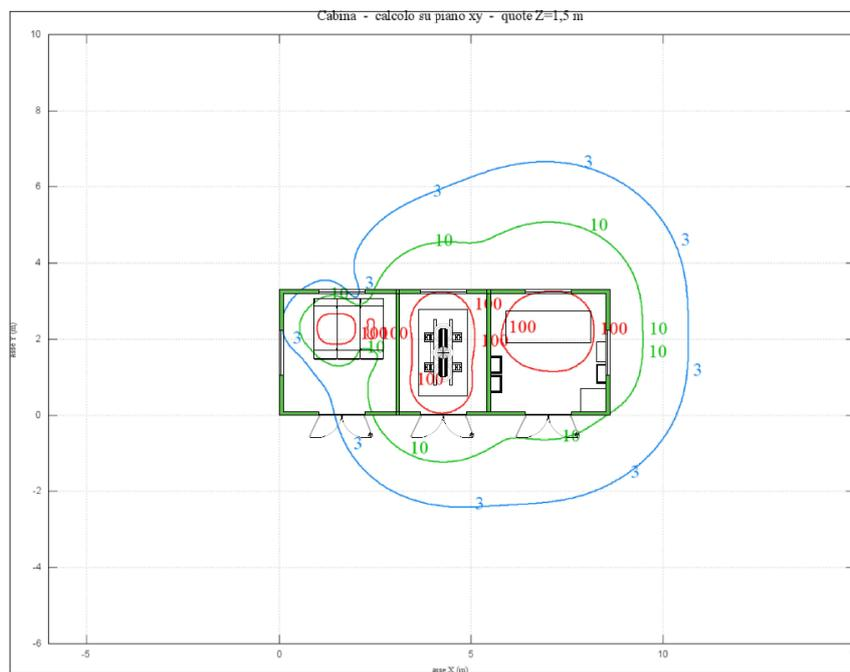
Figura 26: Cabina di Campo,  $h = 1,5\text{ m}$ , curve isolivello
