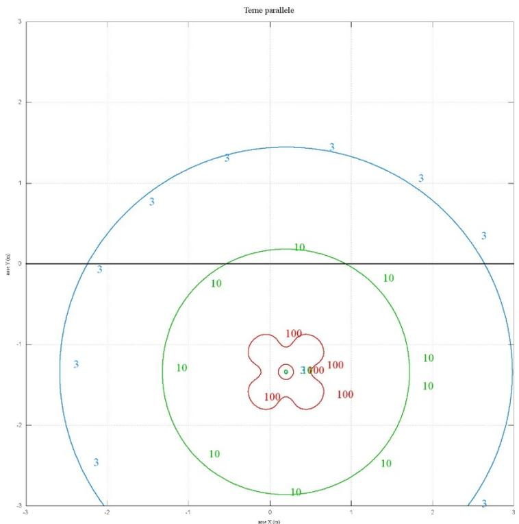
Figura 34: Cavidotto di collegamento MT, 4 terne, curve isolivello
