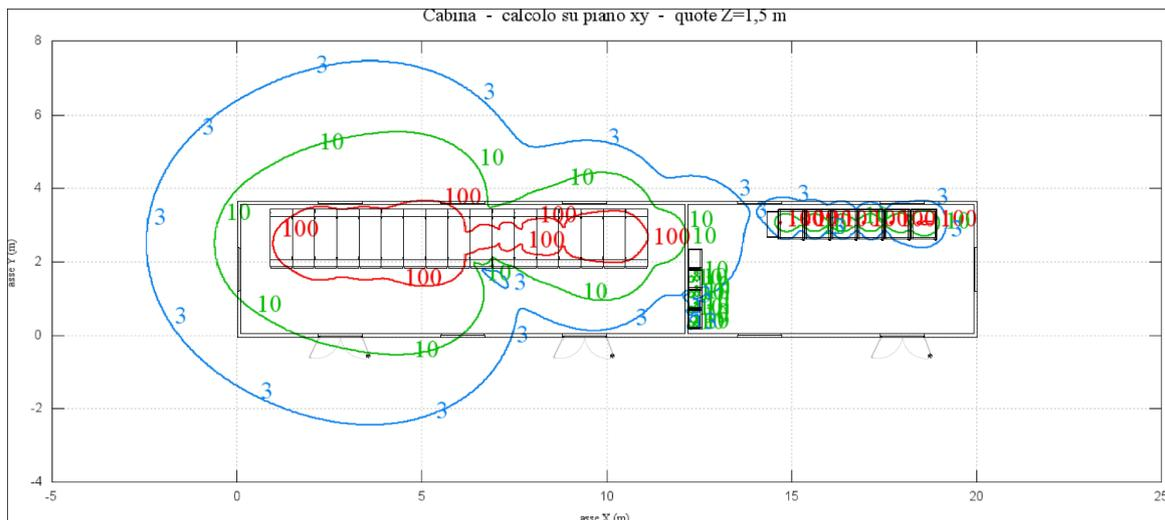
Figura 21: Cabina di Raccolta,  $h = 1,5$  m, curve isolivello
