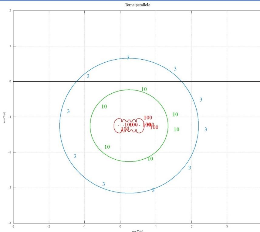
Figura 16: collegamento BT Inverter-Cabina, 10 terne, curve isolivello
