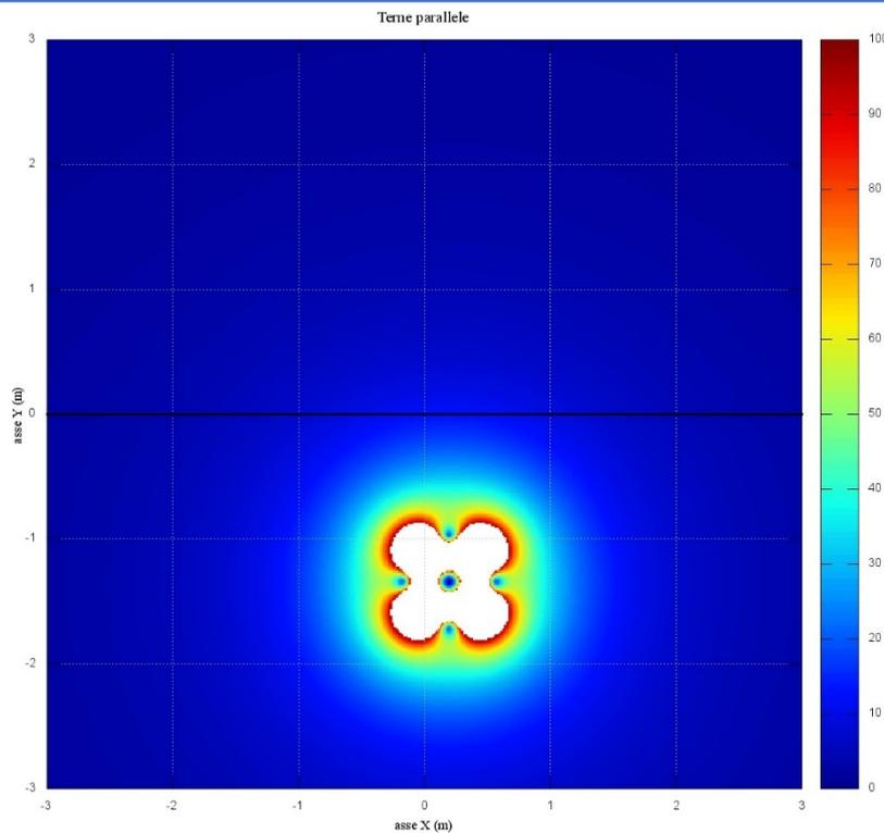
Figura 33: Cavidotto di collegamento MT, 4 terne, mappa 2D
