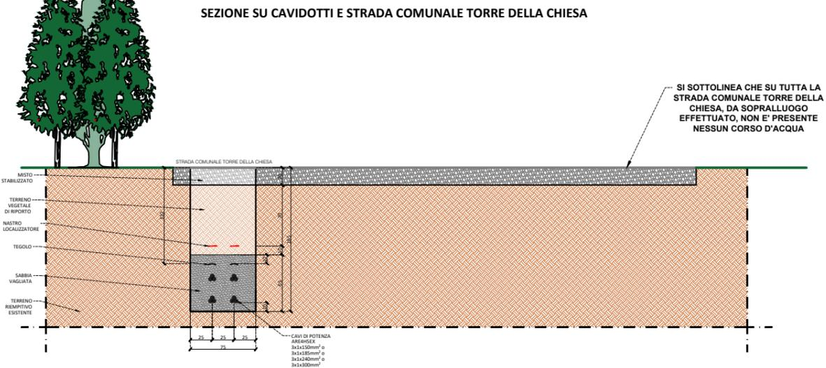
PARTICOLARE INTERSEZIONE TRA FASCIA DI RISPETTO PGRA (NESSUNA PRESENZA DI CORSI D'ACQUA) E CAVIDOTTO MT AC NEL PUNTO "D" - SCALA 1:20
