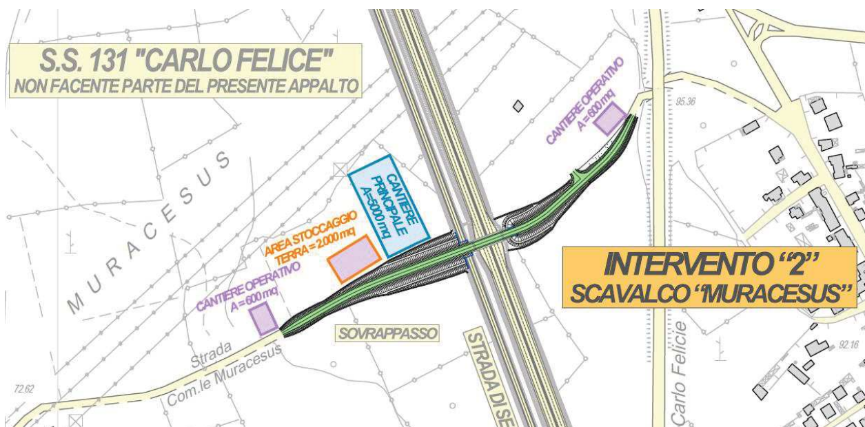
Figura 2. Area di deposito/stoccaggio delle TRS nell'intervento 2
