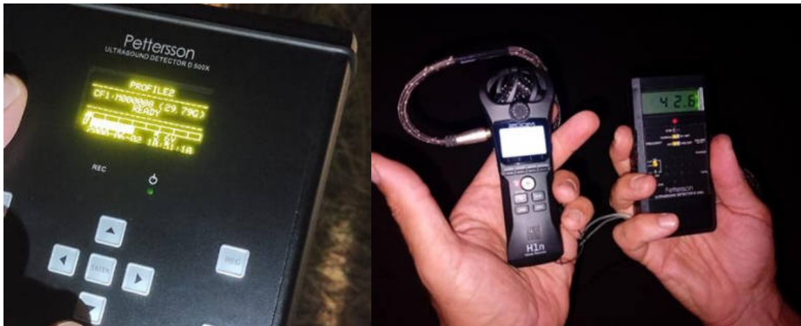
Foto 2 – 3 - Preparazione del Bat Detector Pettersson D500 x per i rilievi su postazione fissa prolungata e D240 per i punti ascolto.
