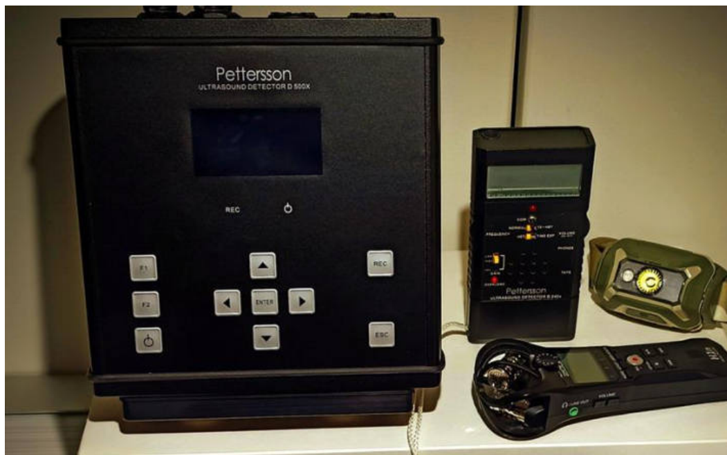
Foto 1 - Attrezzatura utilizzata per il monitoraggio dei chiroteri. Da destra verso sinistra: Bat detector D 500X per la registrazione prolungata in campo degli ultrasuoni. Rilevatore a eterodina ed espansione temporale (D 240 X 10 e x20 selezionabile). Registratore multitraccia collegato al D 240X.
