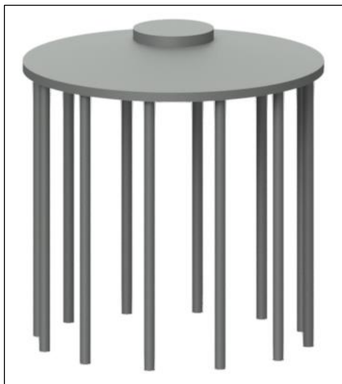
Figura 8: vista tridimensionale della fondazione dell'aerogeneratore
