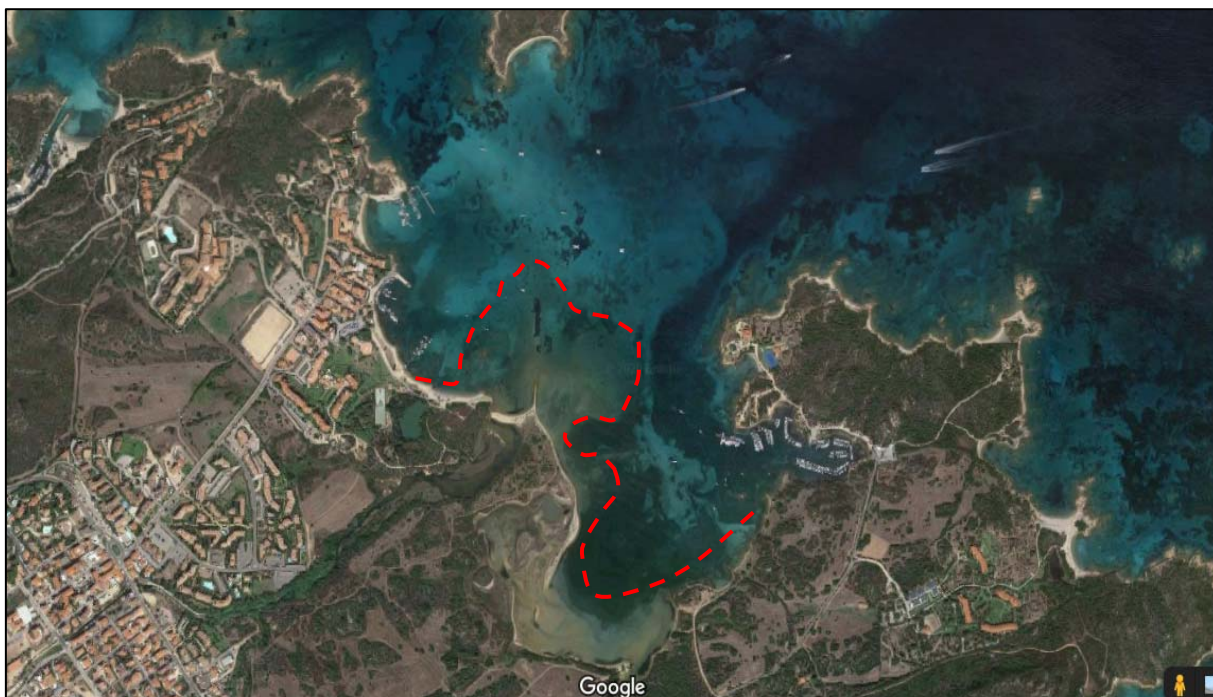
Figura 6.2 – Apporti sedimentari provenienti dal Riu Scalamala; in rosso la distribuzione dei sedimenti prodotta dalle correnti sottocosta locali
