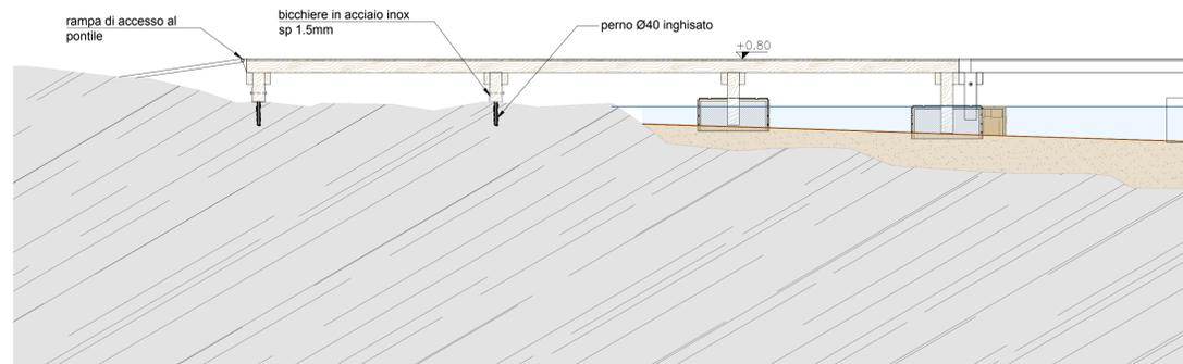
SEZIONE LONGITUDINALE TIPO PONTILE SU PALI
